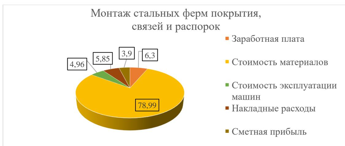
Рисунок 3 – Диаграмма затрат на монтаж стальных ферм покрытия, связей и распорок
