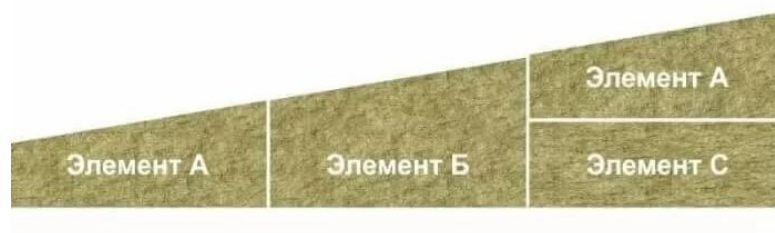
Рисунок В.2 – Схема укладки уклонообразующего слоя.
