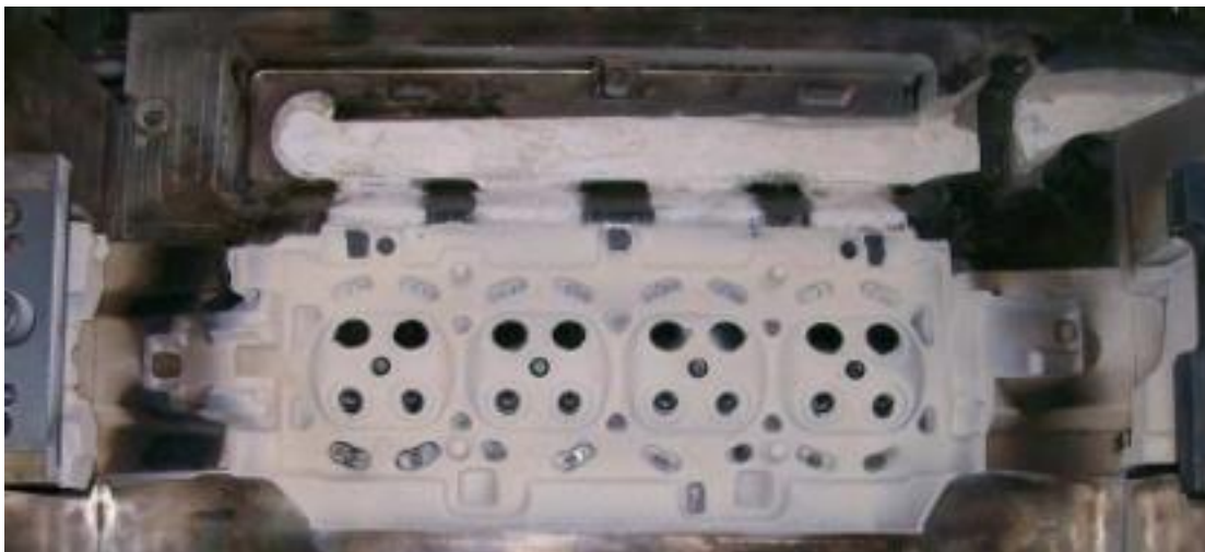
Рисунок 2 – Пример подготовленного и окрашенного кокиля
