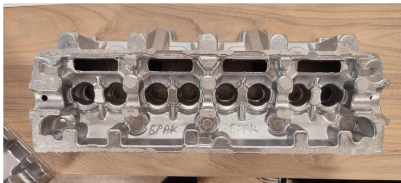
Рисунок 1 – Заготовка «Головка блока цилиндров 11182-1003015-70»
