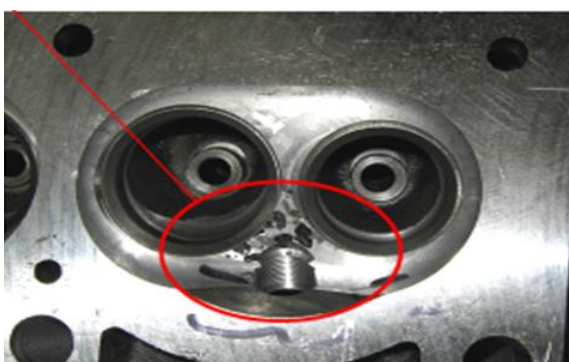
Рисунок 6 – Дефект воздушных раковин в камере сгорания
