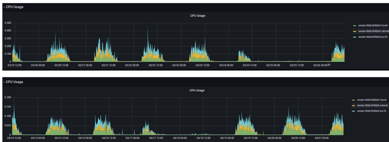
Рисунок 20 – Загрузка CPU до и после оптимизации
