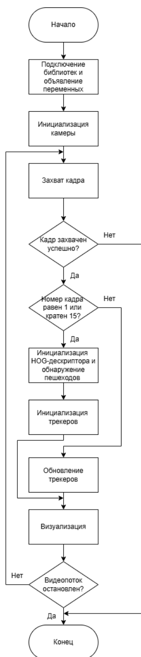
Рисунок 46 – Блок-схема алгоритма работы программного модуля обнаружения пешеходов
