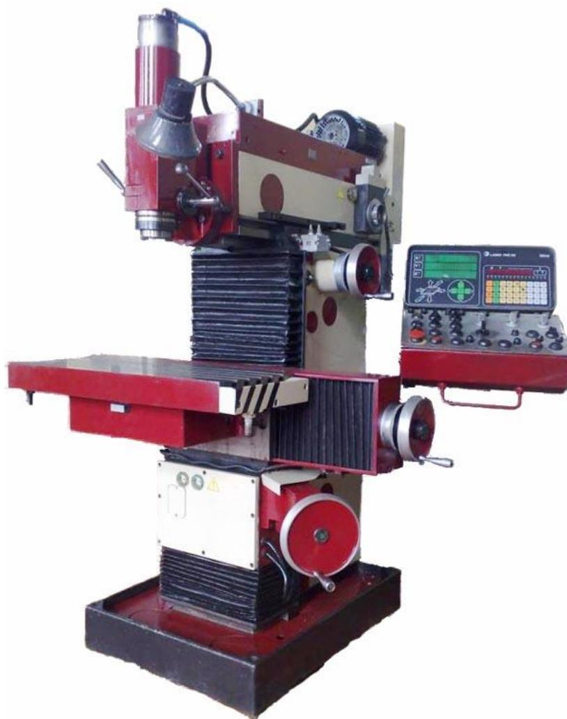
Рисунок 17 – Универсальный фрезерный станок 67K25
