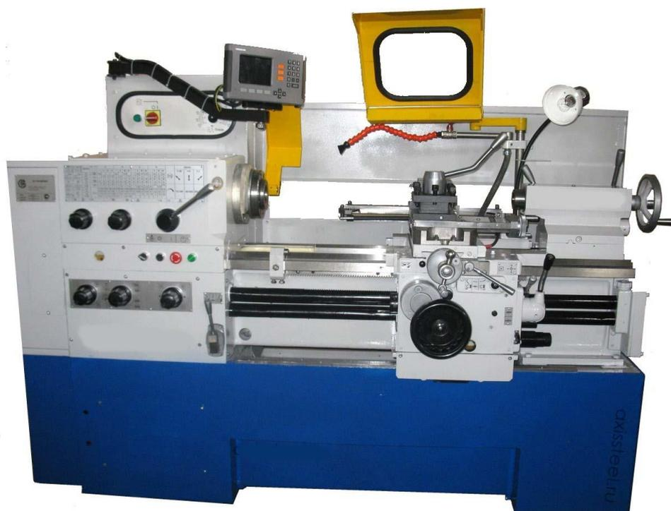
Рисунок 18 – Токарный станок 16Б16ИП
