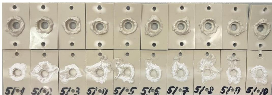
Рисунок 46 – Образцы 5 группы после разрыва ( $F_{пр} = 39,225 \text{ Н}$ )
