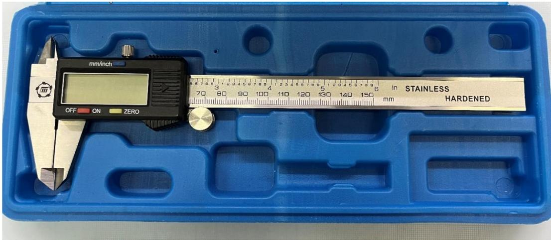
Рисунок 20 – Цифровой штангенциркуль ТУЛАМАШ ШЦЦ-I-150-0,01
