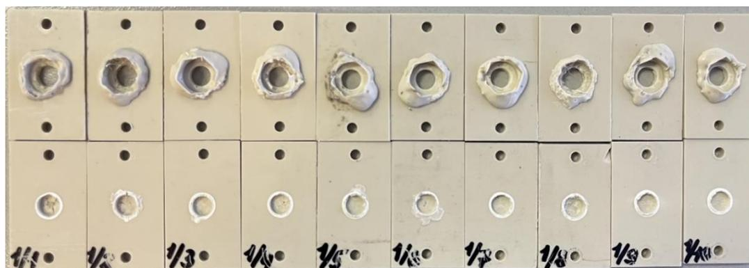
Рисунок 45 – Образцы 1 группы после разрыва ( $F_{пр} = 7,845 \text{ Н}$ )
