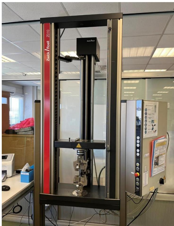
Рисунок 30 – Разрывная машина Zwick / Roell Z010
