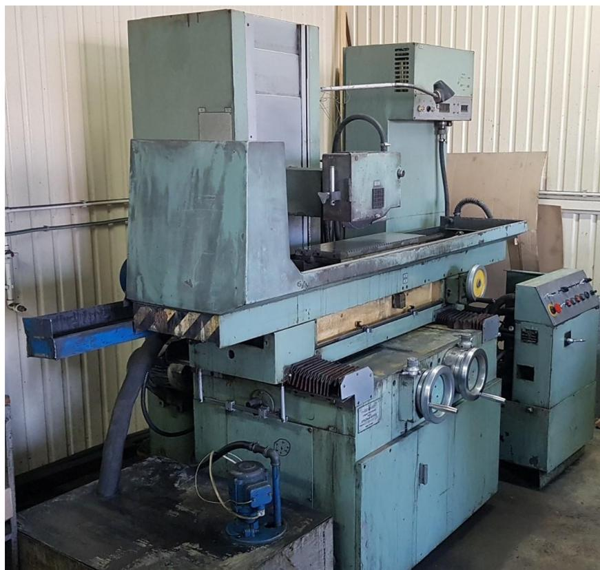
Рисунок 19 – Плоскошлифовальный станок 3E711BФ2
