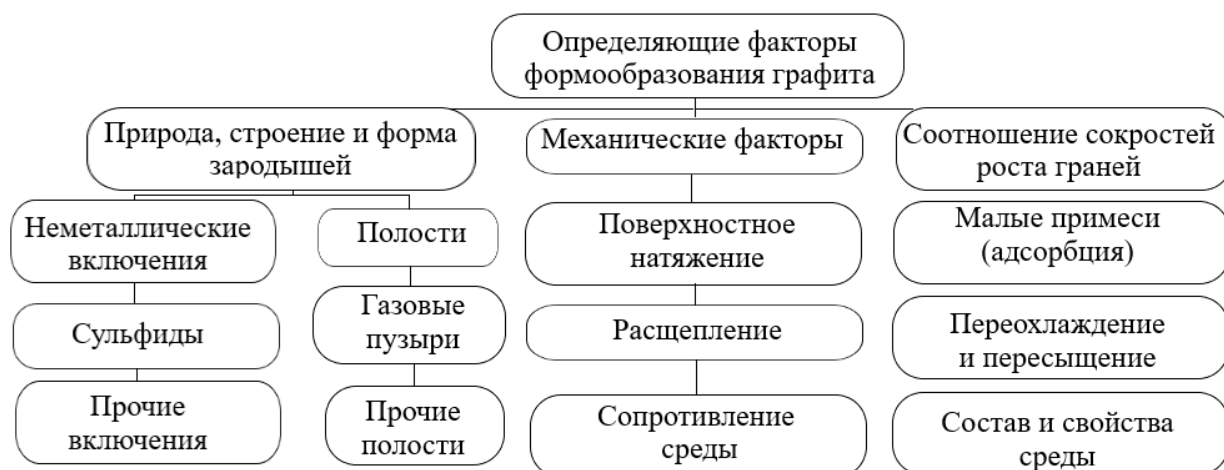
Рисунок 1 – «Схематическое отображении влияющих факторов на формообразование графита» [31]
