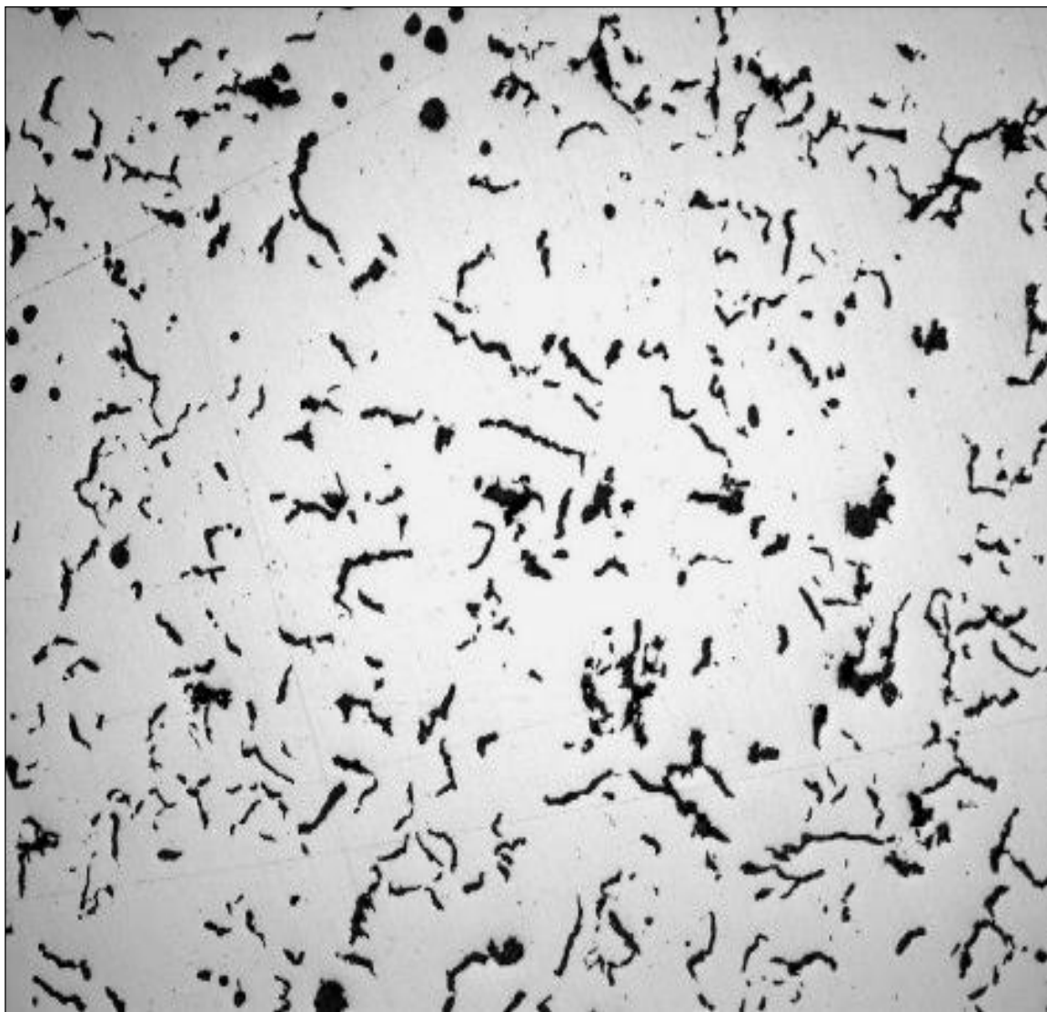
Рисунок 28 – Микроструктура ЧВГ, не травлено
