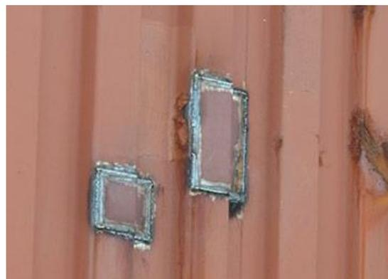
Рисунок 3 – Примеры выполнения сварочных работ при ремонте контейнеров
