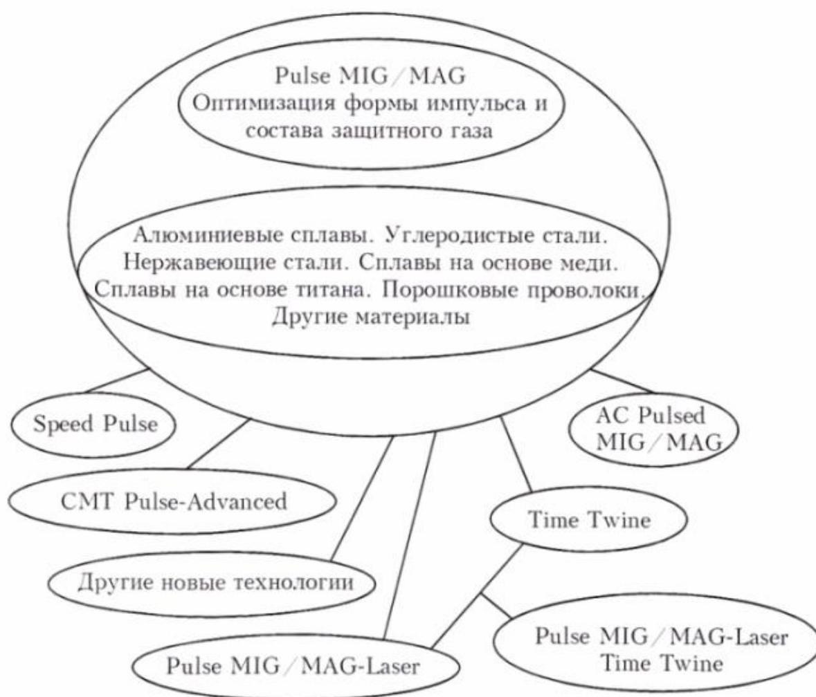
Рисунок 9 – Разновидности алгоритмов управления, обеспечивающих протекание сварки в импульсном режиме горения дуги и переноса электродного металла
