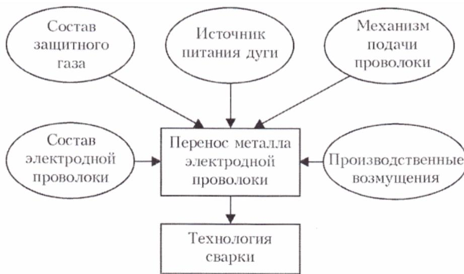
Рисунок 7 – Влияние основных составляющих процесса сварки на характер переноса электродного металла
