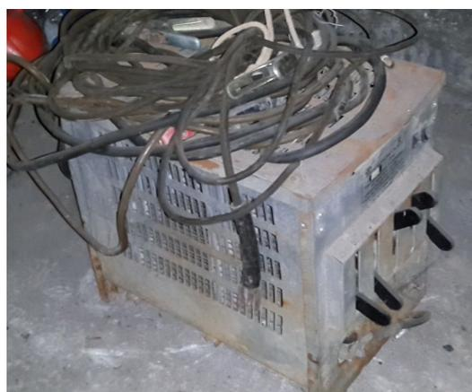
Рисунок 3 – Применяемый при реализации базового технологического процесса сварочный выпрямитель ВДУ-301 и балластный реостат РБУ-400
