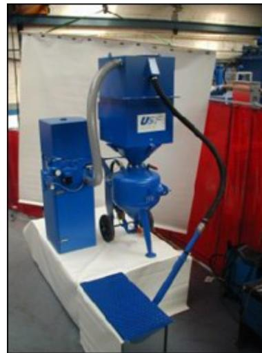
Рисунок 16 – Мобильные дробеструйные установки
