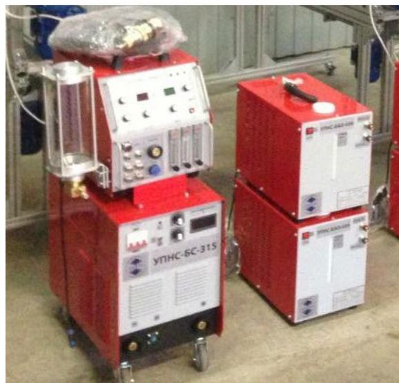
Рисунок 19 – Оборудование для комплектации поста наплавки
