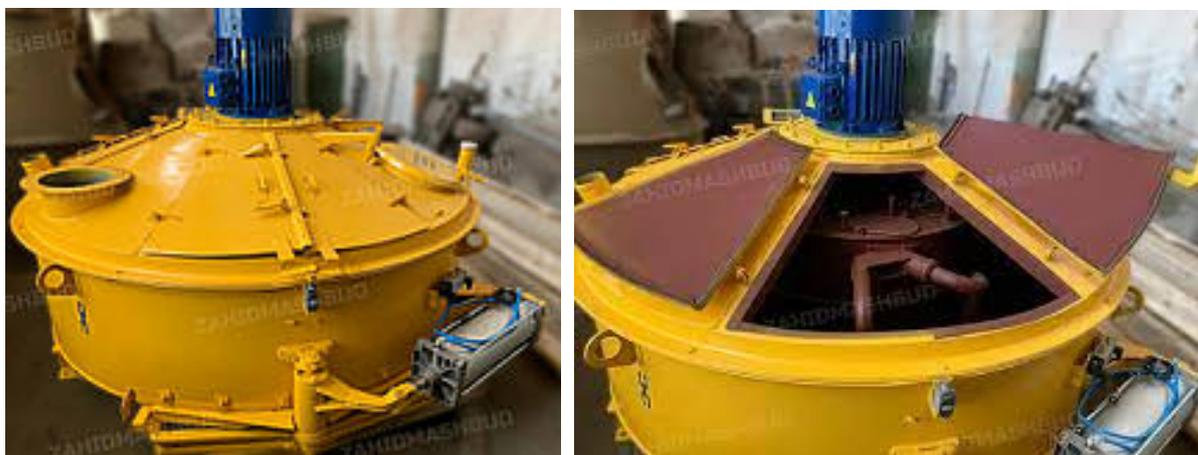
Рисунок 1 – Смеситель СБ-138 для приготовления цементной смеси
