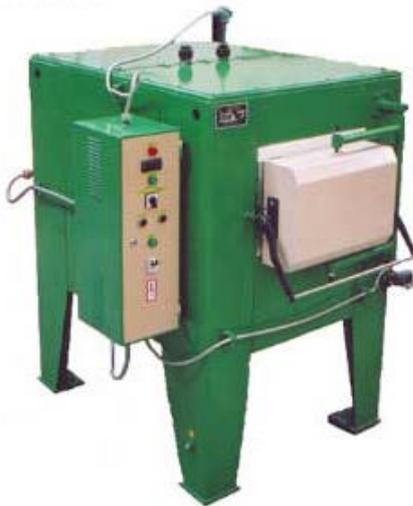
Рисунок 4 – Электрическая печь СНО 3.6.2/10, применяемая в базовой технологии для термической обработки деталей после наплавки
