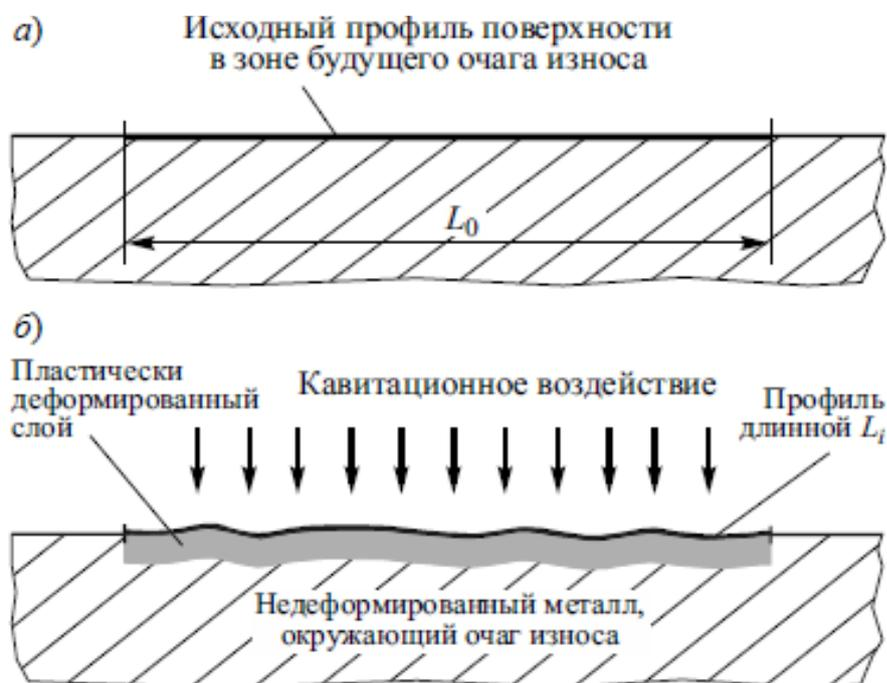
Рисунок 3 – Схема профиля исходной поверхности и поверхности после кавитационного воздействия
