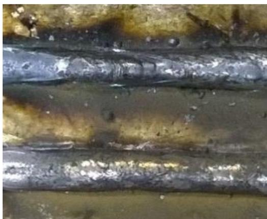
Рисунок 14 – Сравнительный анализ валиков, наплавленных с применением равномерной подачи проволоки и импульсной подачи проволоки
