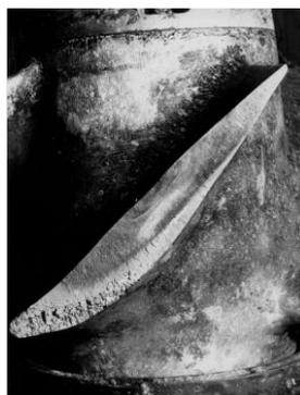
Рисунок 1 – Разрушение лопасти гребного винта
