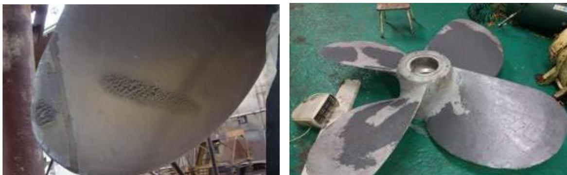
Рисунок 6 – Коррозионный и эрозионный износ гребного винта
