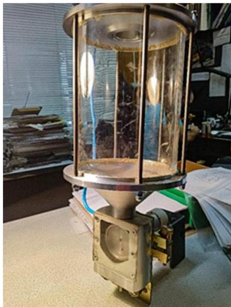
Рисунок 22 – Порошковый питатель барабанного типа
