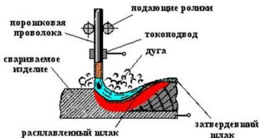
Рисунок 8 – Схема выполнения сварки порошковой проволокой
