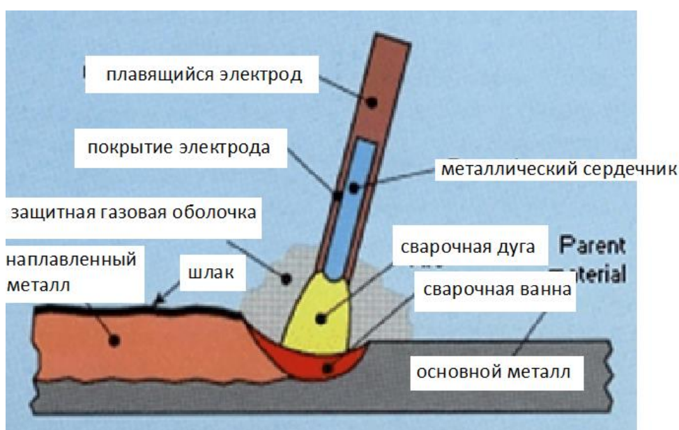
Рисунок 5 – Схема выполнения ручной дуговой сварки
