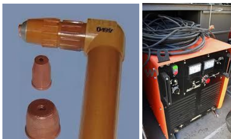
Рисунок 12 – Оборудование для плазменной разделки трещины перед ремонтной сваркой
