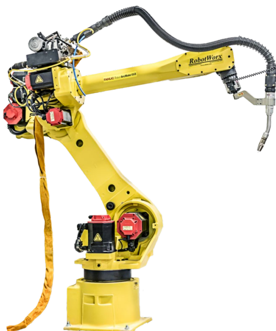
Рисунок 22 – Промышленный сварочный робот производства концерна FANUC Robotics модификации Arc Mate 120 iB
