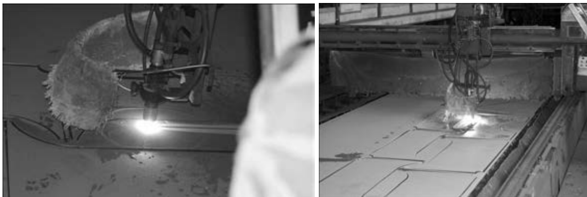
Рисунок 23 – Выполнение плазменной резки на судостроительных предприятиях с применением добавок воды в плазмообразующую среду
