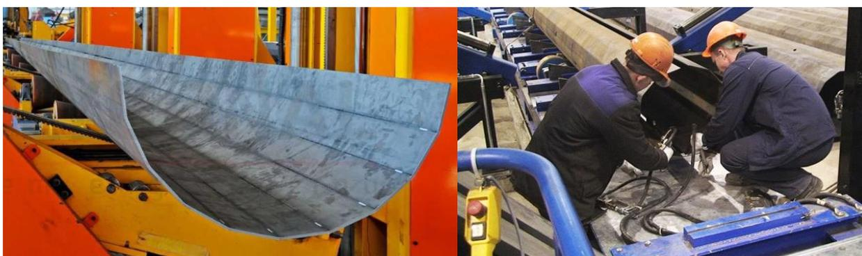
Рисунок 6 – Сборка секции с применением ручной дуговой сварки
