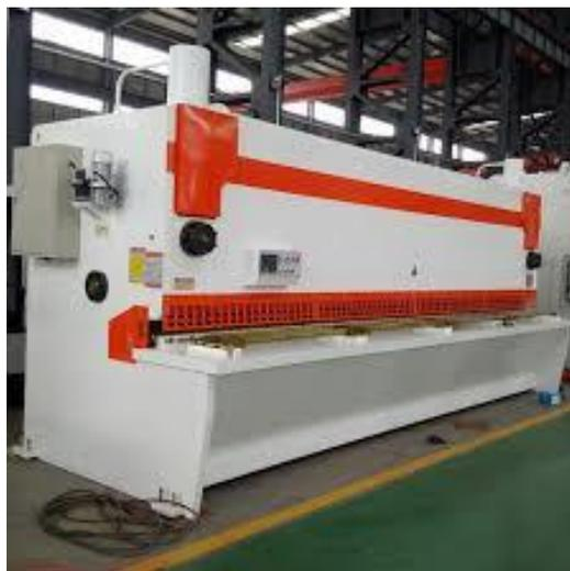
Рисунок 24 – Гильотинная машина для нарезки листового проката
