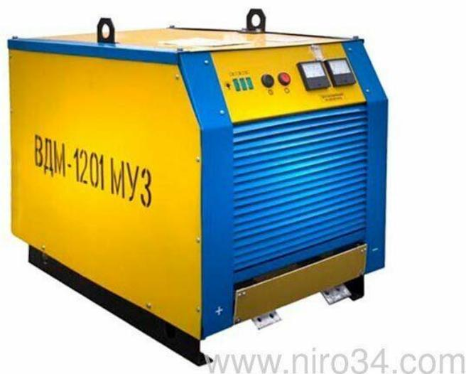
Рисунок 28 – Сварочный выпрямитель ВДМ-1201
