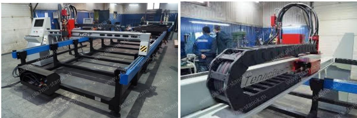
Рисунок 25 – Машина плазменной резки
