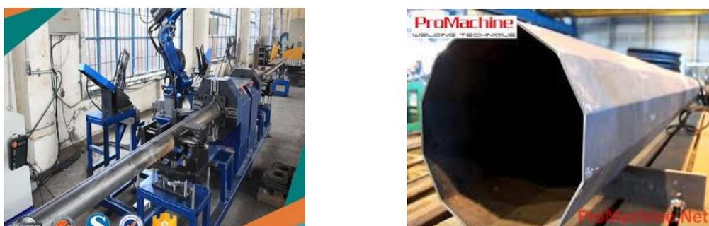
Рисунок 11 – Пример роботизированной сварки многогранных опор
