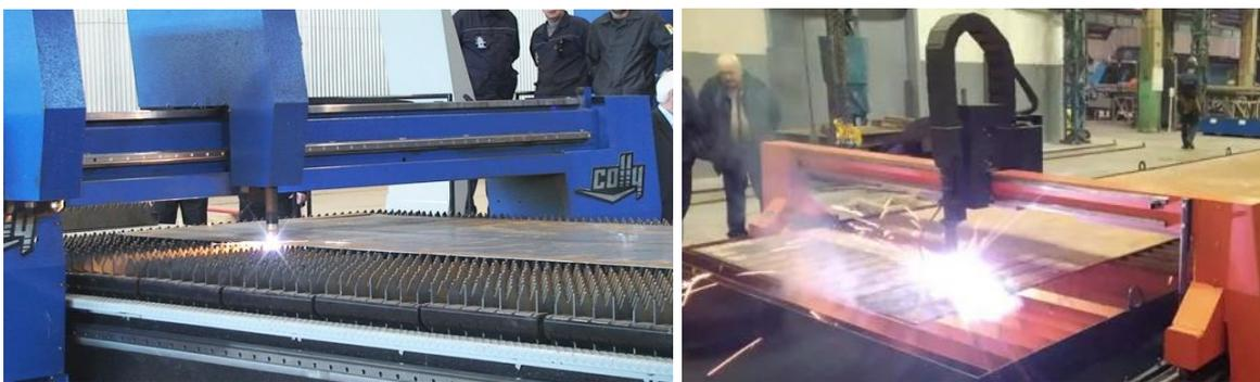
Рисунок 4 – Плазменный раскрой листовых заготовок для получения конического профиля
