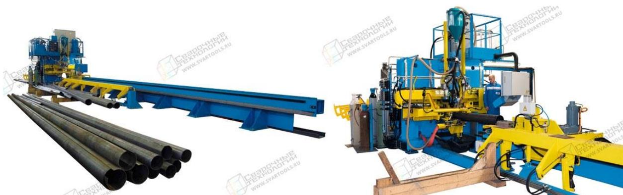
Рисунок 29 – Сварочный портал для линейного перемещения горелки при изготовлении опор многогранных
