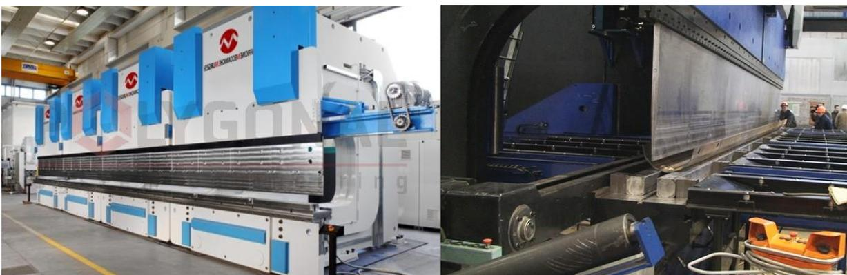
Рисунок 5 – Гибка листовых заготовок для получения конической секции
