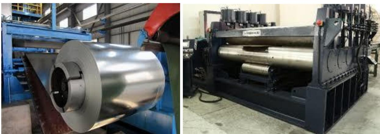
Рисунок 23 – Правка листового проката для получения заготовок
