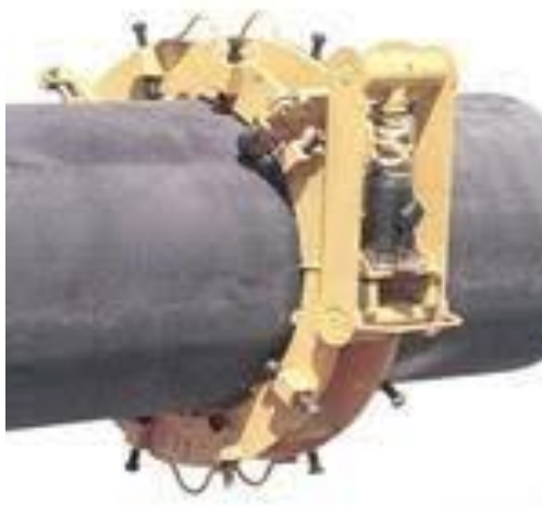
Рисунок 5 – Сборка труб с применением внешнего центриатора
