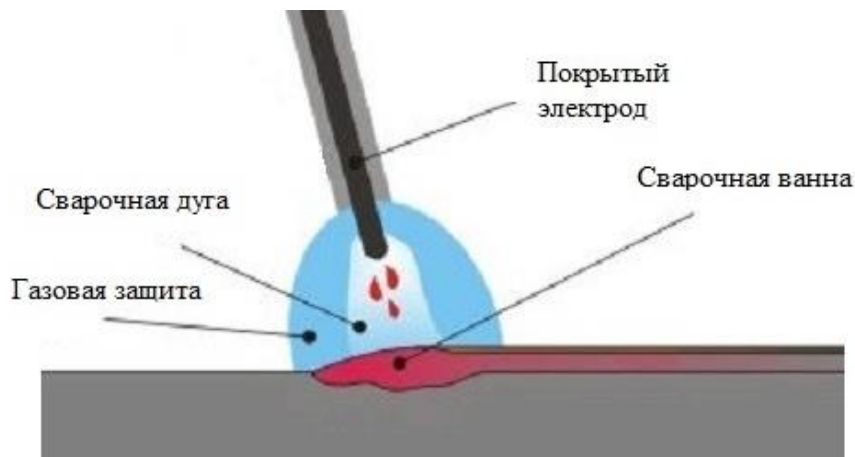
Рисунок 8 – Схема ручной дуговой сварки
