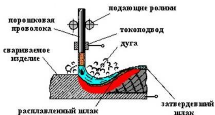
Рисунок 11 – Схема выполнения сварки самозащитной проволокой
