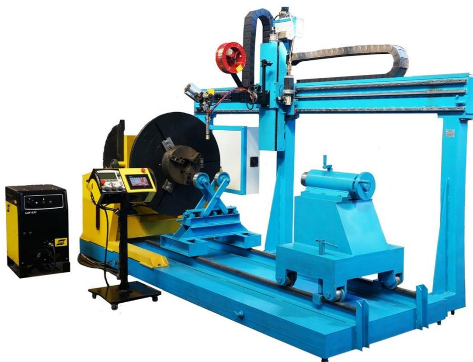
Рисунок 14 – Установка плазменной наплавки распределителей
