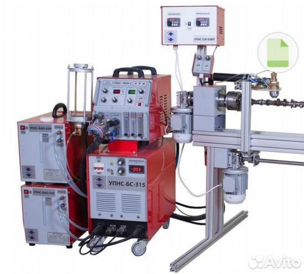
Рисунок 17 – Установка для наплавки распредвалов техники
