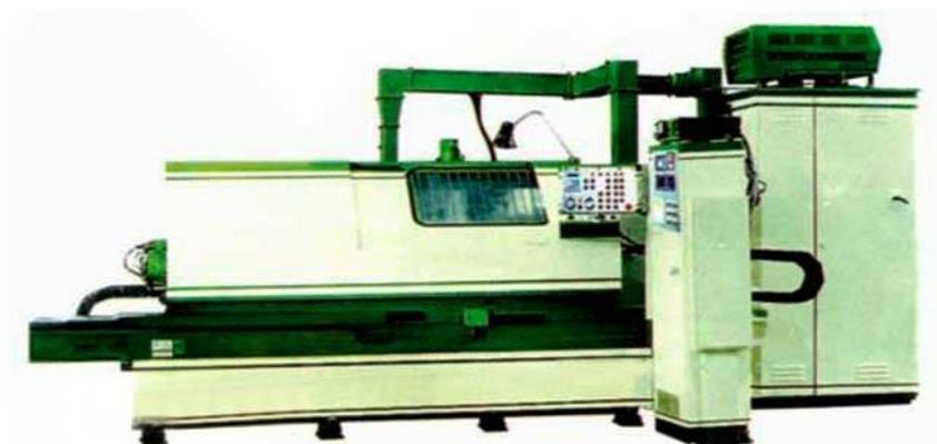
Рисунок 22 – Копировально-шлифовальный станок для обработки поверхности кулачков распределительного вала
