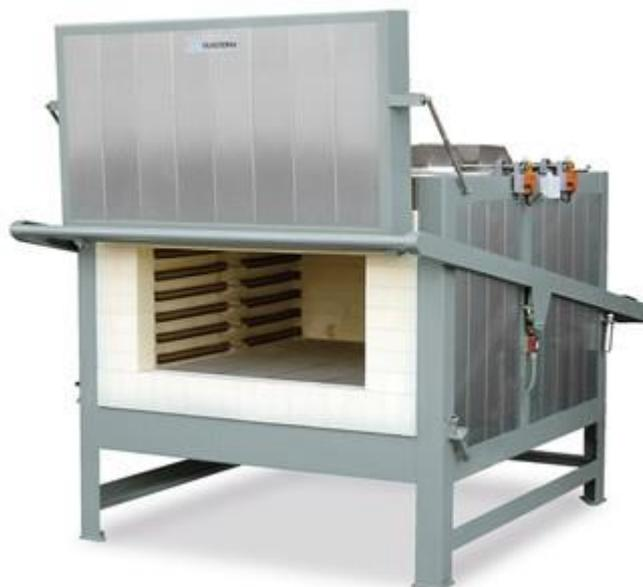
Рисунок 6 – Электрическая печь для термической обработки валов
