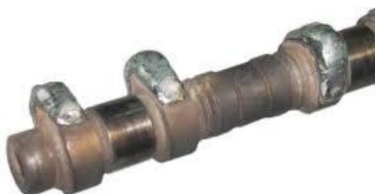
Рисунок 9 – Пример наплавленных кулачков вала
