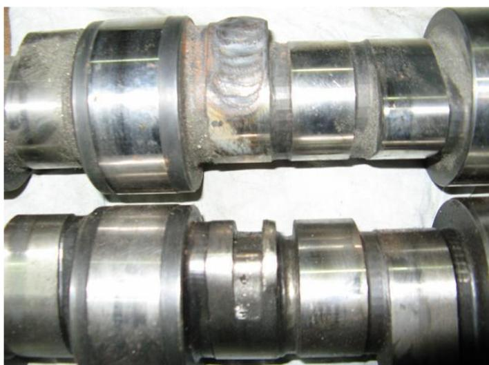
Рисунок 10 – Пример восстановительной наплавки с применением проволоки сплошного сечения
