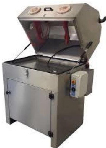
Рисунок 5 – Моечная машина
