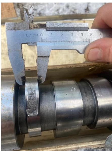
Рисунок 7 – Оценка состояния распределительного вала
