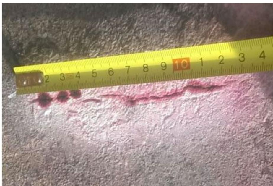
Рисунок 22 – Обнаружение подповерхностного дефекта капиллярным методом
