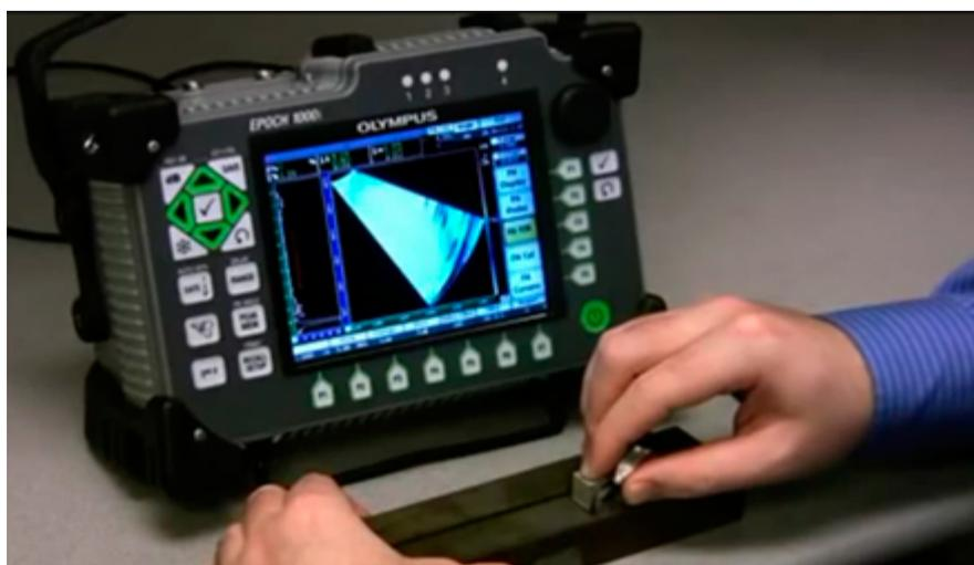
Рисунок 10 – Ультразвуковой дефектоскоп Olympus NDT 1000i
