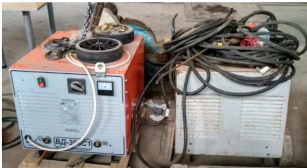
Рисунок 3 – Сварочный выпрямитель ВД-306
