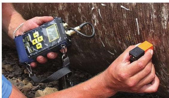
Рисунок 5 – Определение остаточной толщины трубопровода с применением ультразвукового толщиномера
