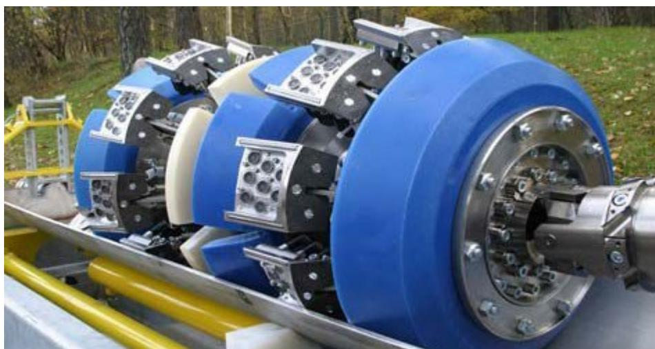
Рисунок 13 – Внутритрубный поршень для ультразвуковой диагностики состояния трубопровода
