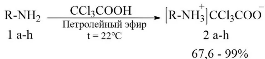
Рисунок 9 - Реакция синтеза амина с трихлоруксусной кислотой
