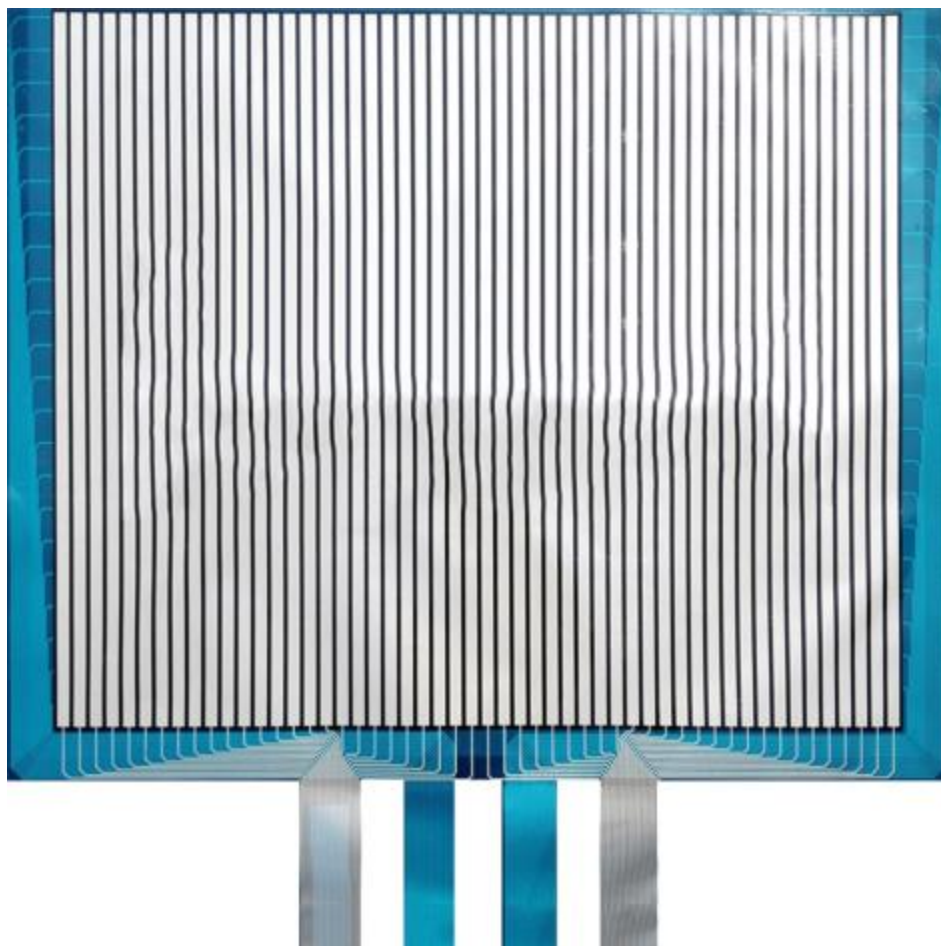
Рисунок 10 – Датчик давления Taidacent FPC
