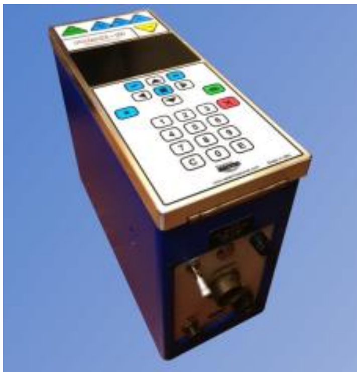
Рисунок 6 - Контроллер Force 3, входящий в систему UHPV
