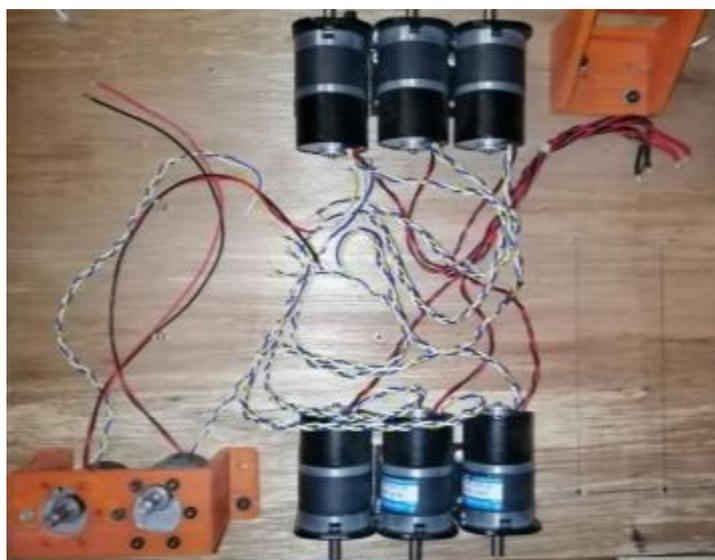
Рисунок 27 – Сборка стенда для отладки платы
