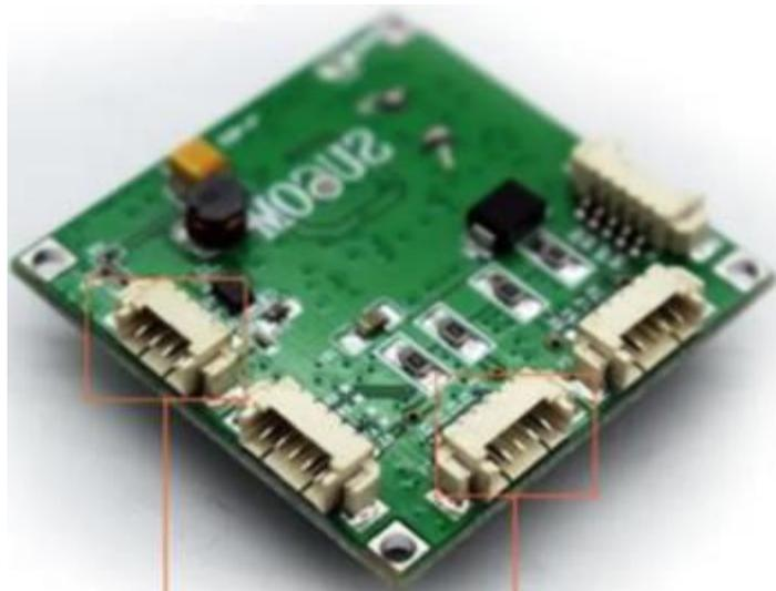
Рисунок 3 – Сетевой коммутатор ANDDEAR-5-8
