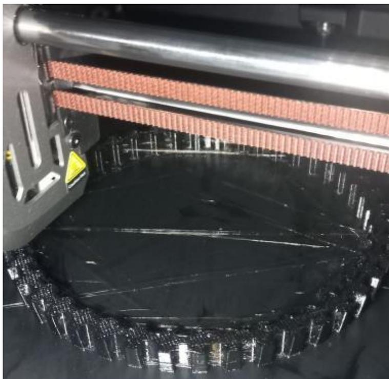
Рисунок 16 – Изготовление гусениц из термополиуретана А95
