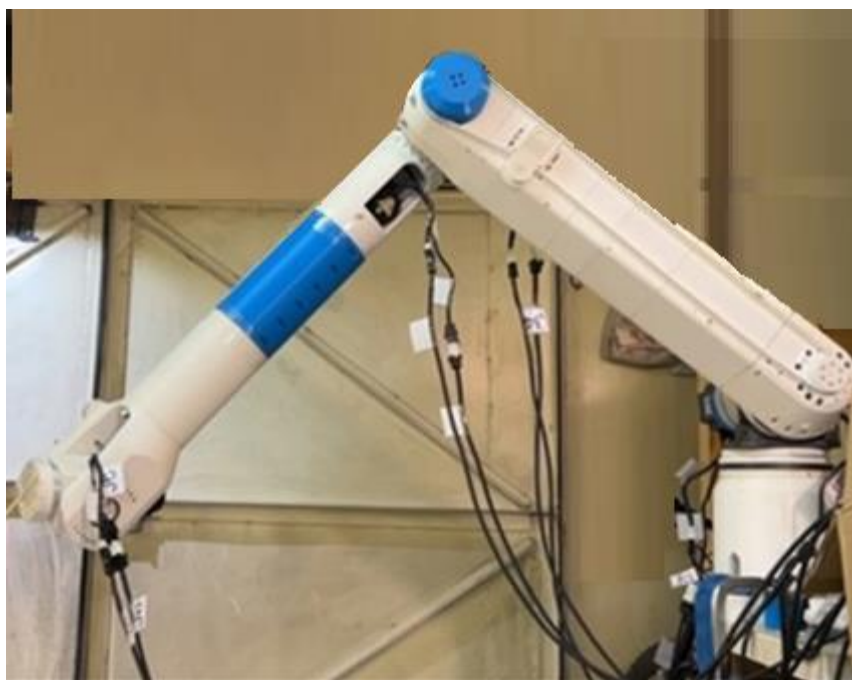
Рисунок 36 – Доработка корпуса робота-манипулятора
