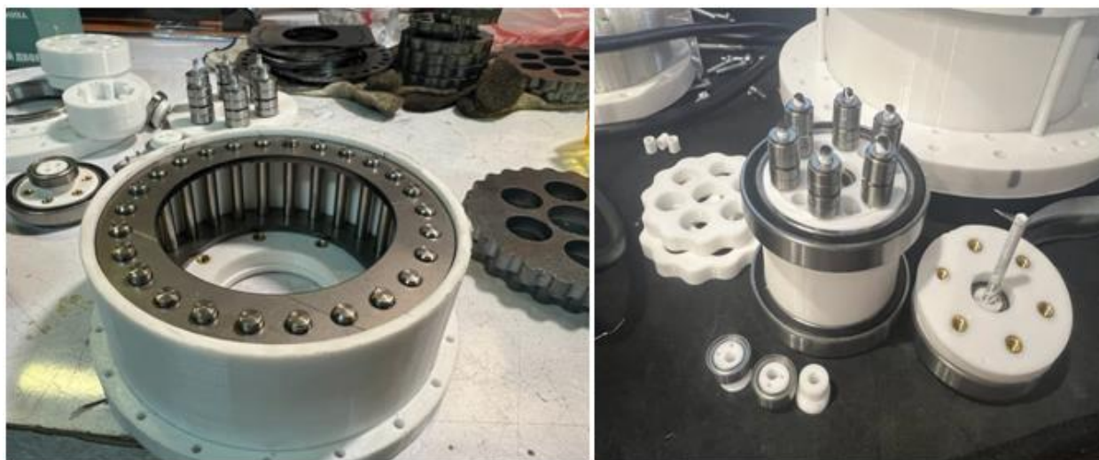
Рисунок 29 – Процесс сборки редукторов
