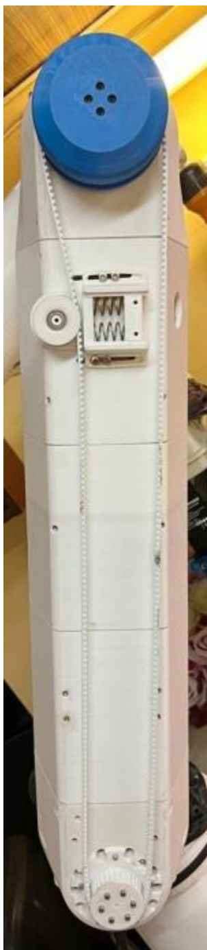
Рисунок 32 – Ременная передача в сборе на плече робота-манипулятора
