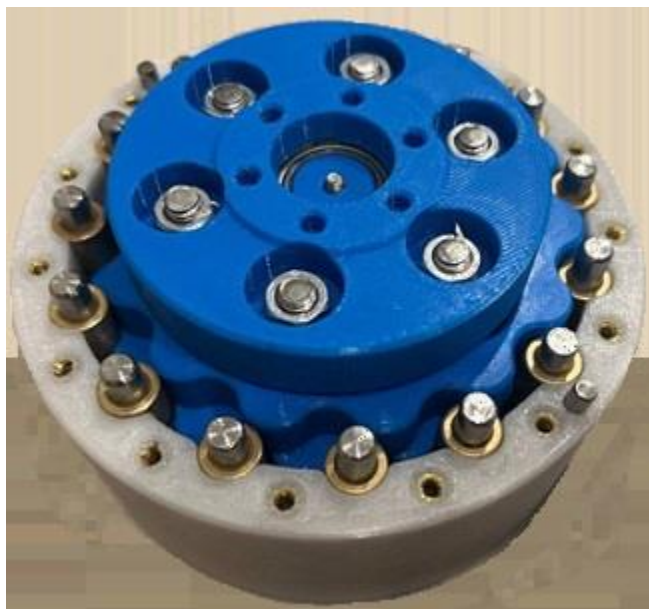
Рисунок 7 – Циклоидальный двухступенчатый редуктор
