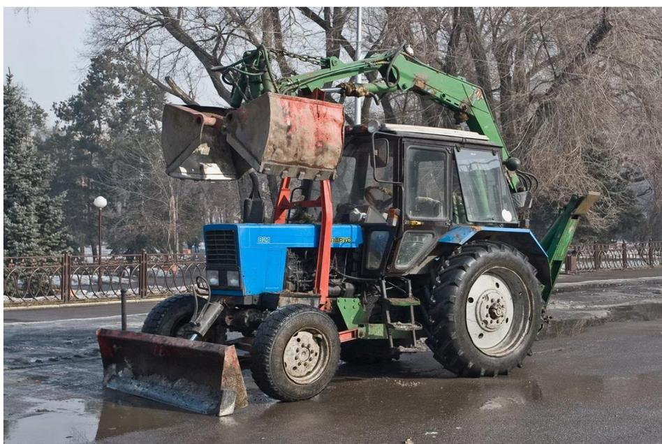
Рисунок 2 – Навесной погрузчик-экскаватор ПЭ-0,85
