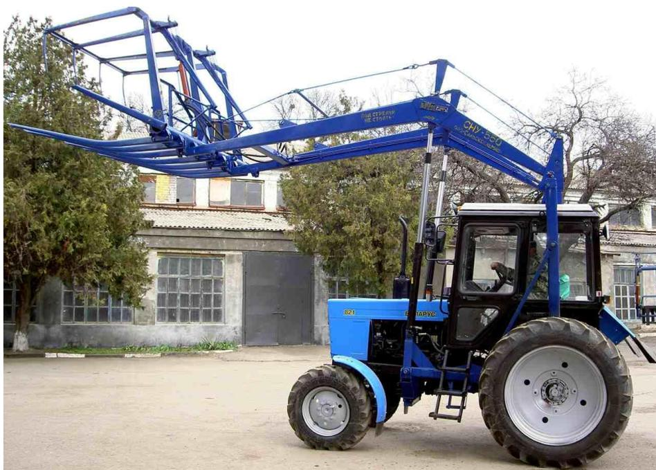
Рисунок 4 – СтогOMETатель-погрузчик СНУ-550
