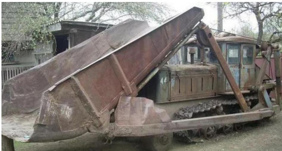
Рисунок 1 – Навесной погрузчик-бульдозер ПБ-35
