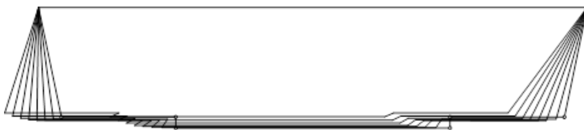
Рисунок 9 – Определение зависимости углов поворота колес графическим методом
