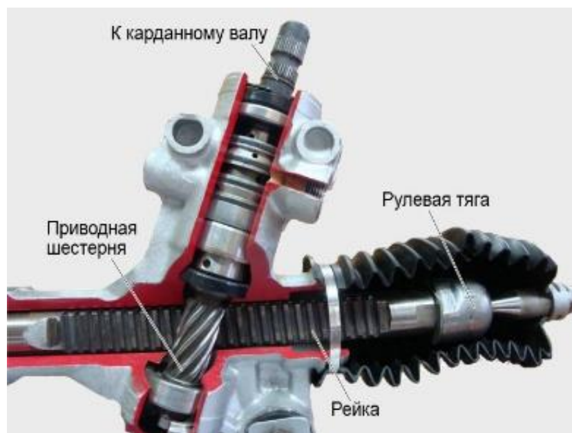
Рисунок 6 – Зубчатый рулевой механизм.
