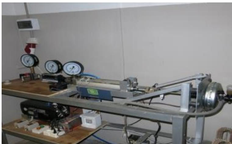
Рисунок 2 – Стенд для проверки автомобильных вакуумных усилителей тормозов
