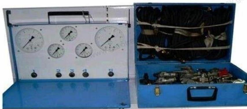
Рисунок 11 Стенд для тестирования НР-108п
