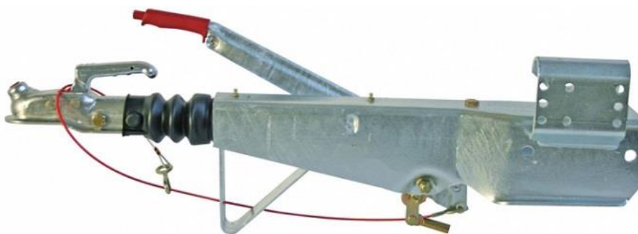
Рис.2 - Механизм тормоза наката
