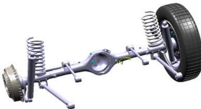
Рисунок 1 – Зависимая задняя подвеска автомобиля Lada Niva
