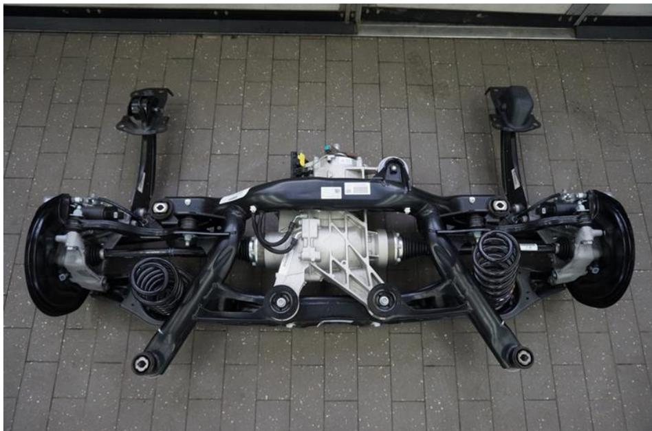
Рисунок 4 – Многорычажная задняя подвеска автомобиля Volkswagen Tiguan
