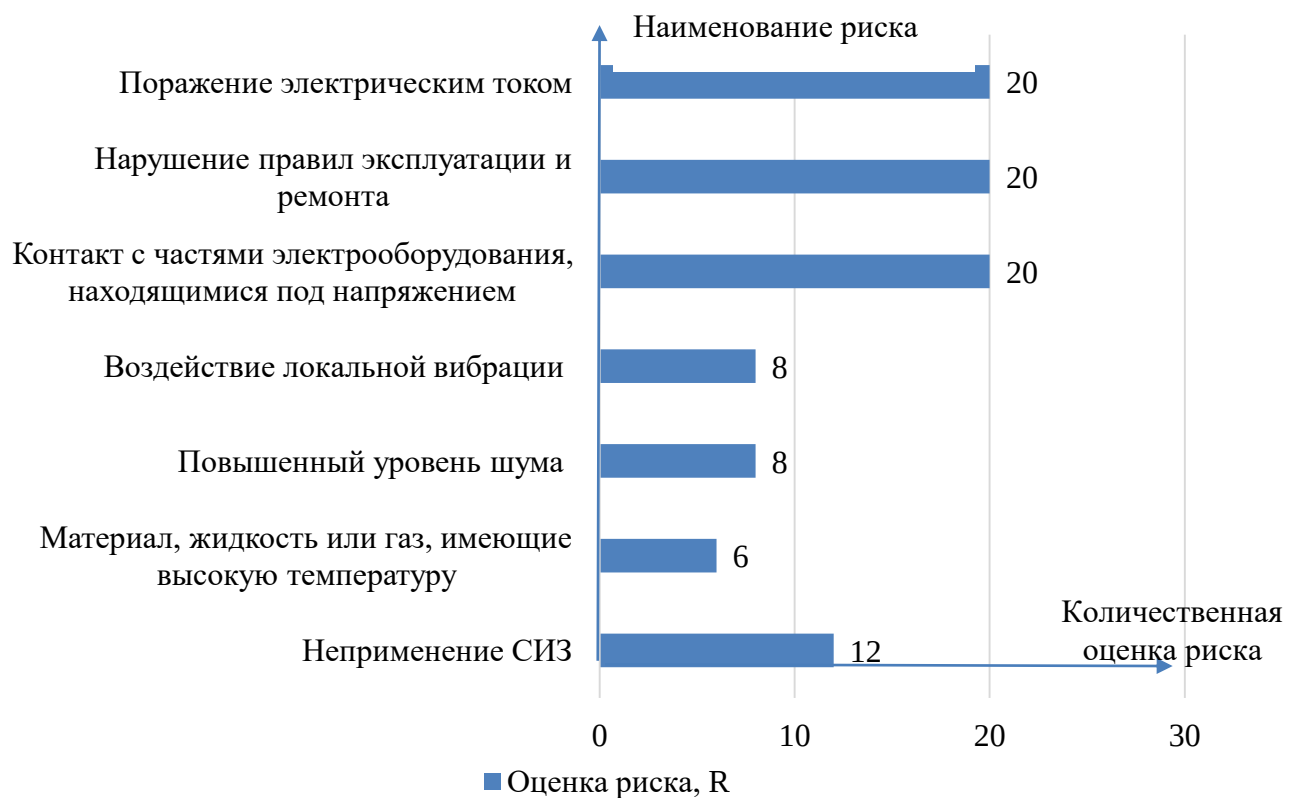
Рисунок 6 – Диаграмма по уровню рисков для рабочего места электромонтажника по кабельным сетям
