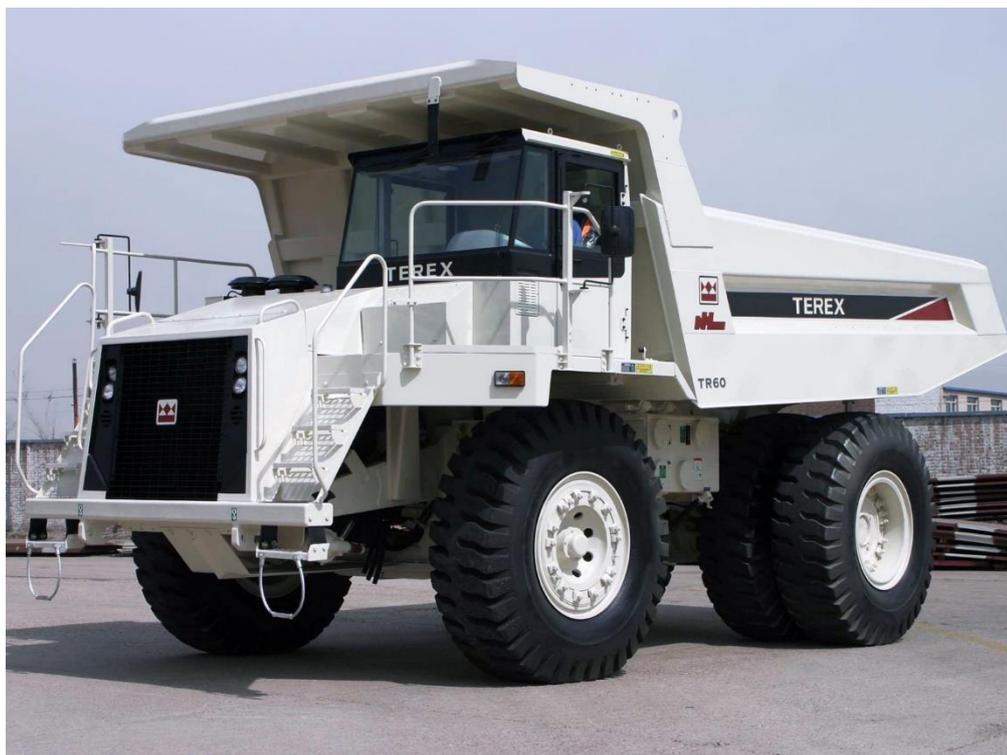
Рисунок 4 – Карьерный самосвал Terex TR60
