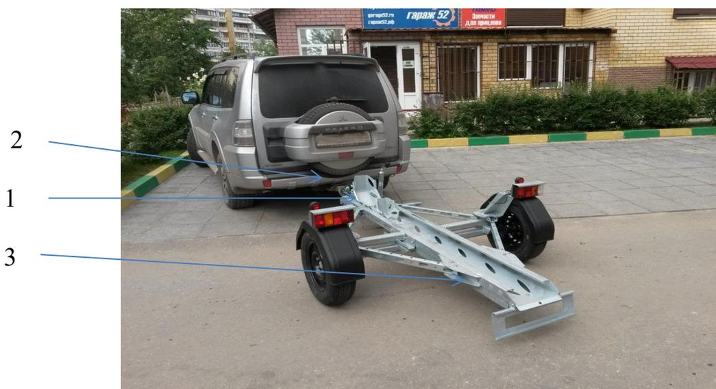
1 – «стяжки, 2 – прицепное устройство 3 - основание
