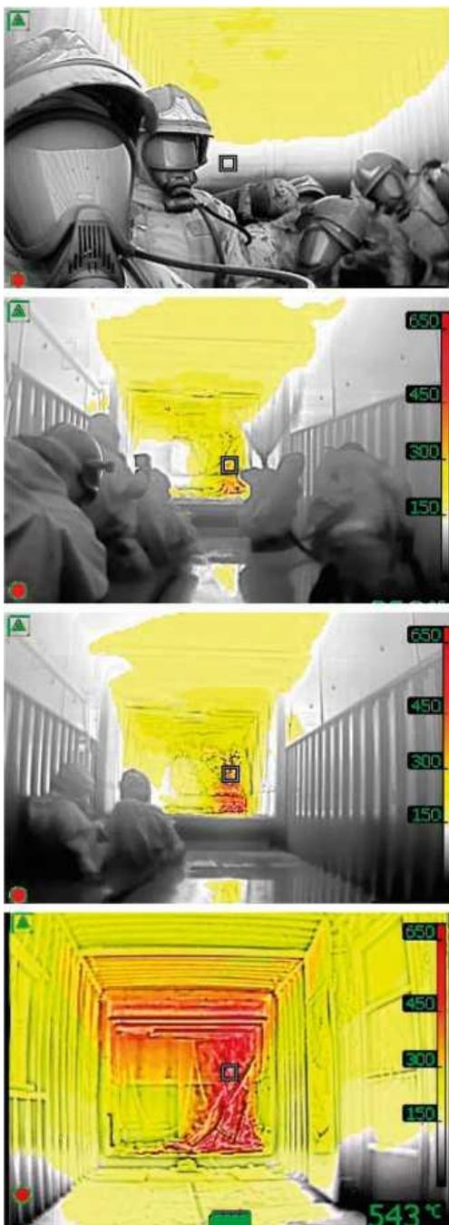
Рисунок 6 – Регистрация температур во время обучения с помощью тепловизионной камеры [19]
