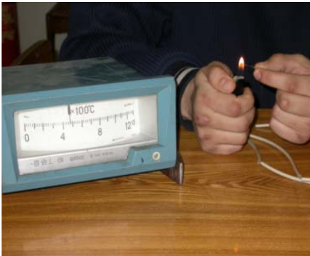
Рис.1.6. Проверка работоспособности термопары
