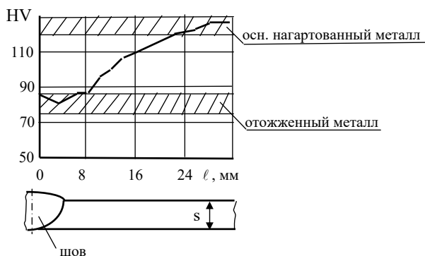
Рис. 7.42. Распределение твердости по Вickers в сварном соединении из сплава АМг6 ( s = 2,8 мм)
