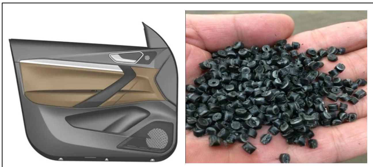
Рисунок 6 – Обивка двери LADA VESTA NG и сырье полипропилен (PP).
