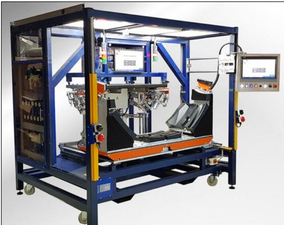
Рисунок 10 – Проект ультразвуковой сварочной машины для деталей Polo и Rapid, решетки бампера.
