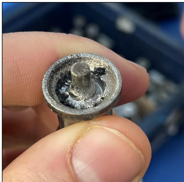
Рисунок 24 – Сонотрод с дефектом
