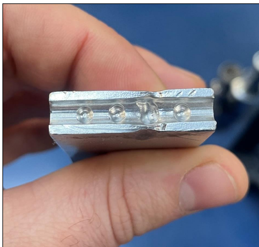
Рисунок 23 – Соноотрод с дефектом
