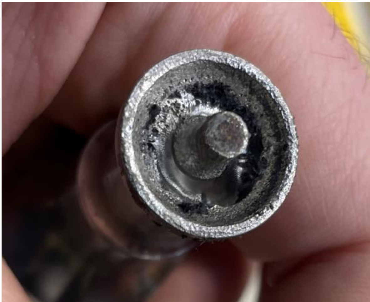
Рисунок 29 – Результаты испытаний с материалом BT1-0.
