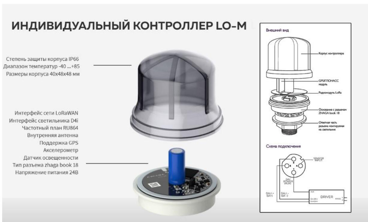
Рисунок 16 – Контроллер LoRa AWADA LO-M для управления уличными осветительными приборами
