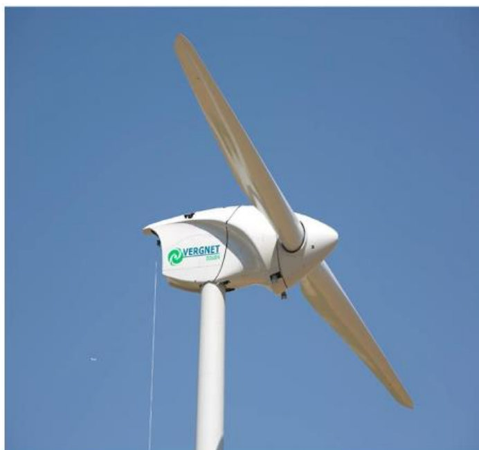
Рисунок 17 – Внешний вид двухлопастного ветрогенератора
