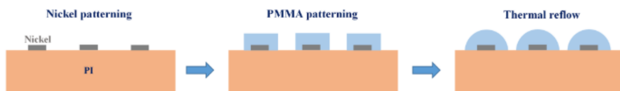
Рисунок 22 – Метод изготовления подложки из ПММА при помощи метода типового оплавления
