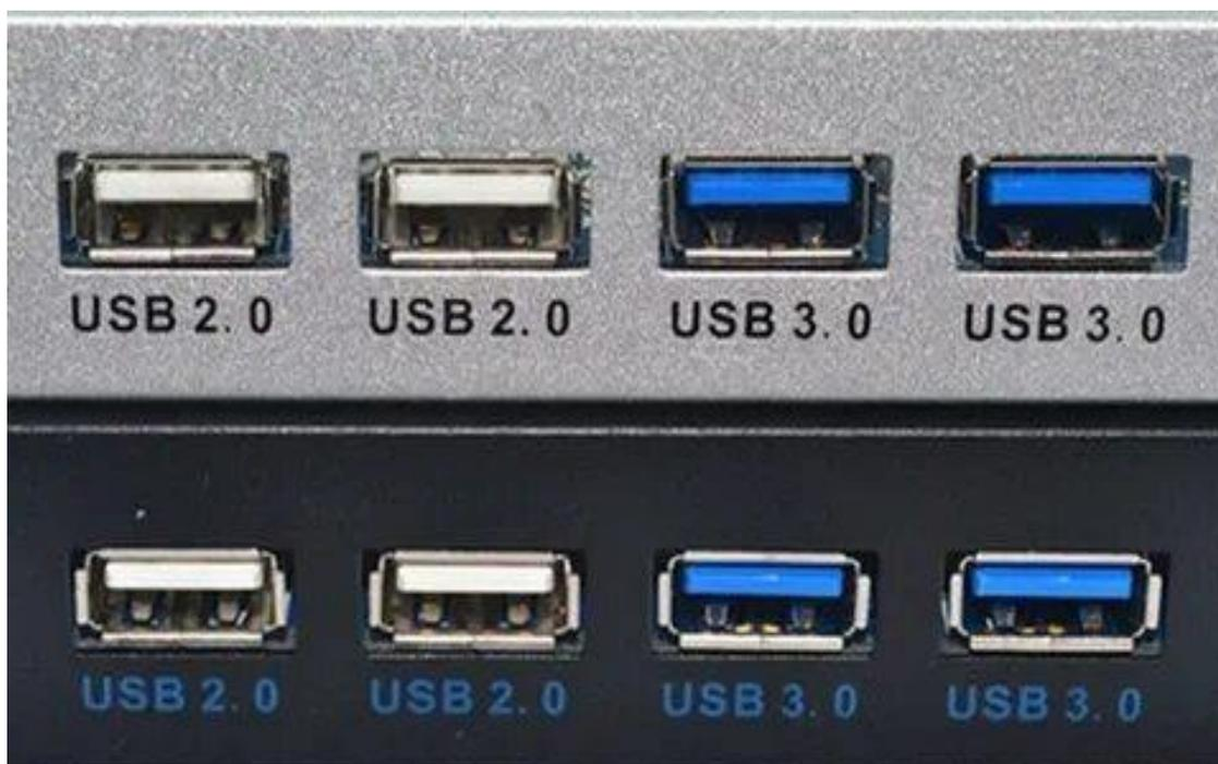
Рисунок 41 - Совместное расположения портов USB 2.0 и USB 3.0
