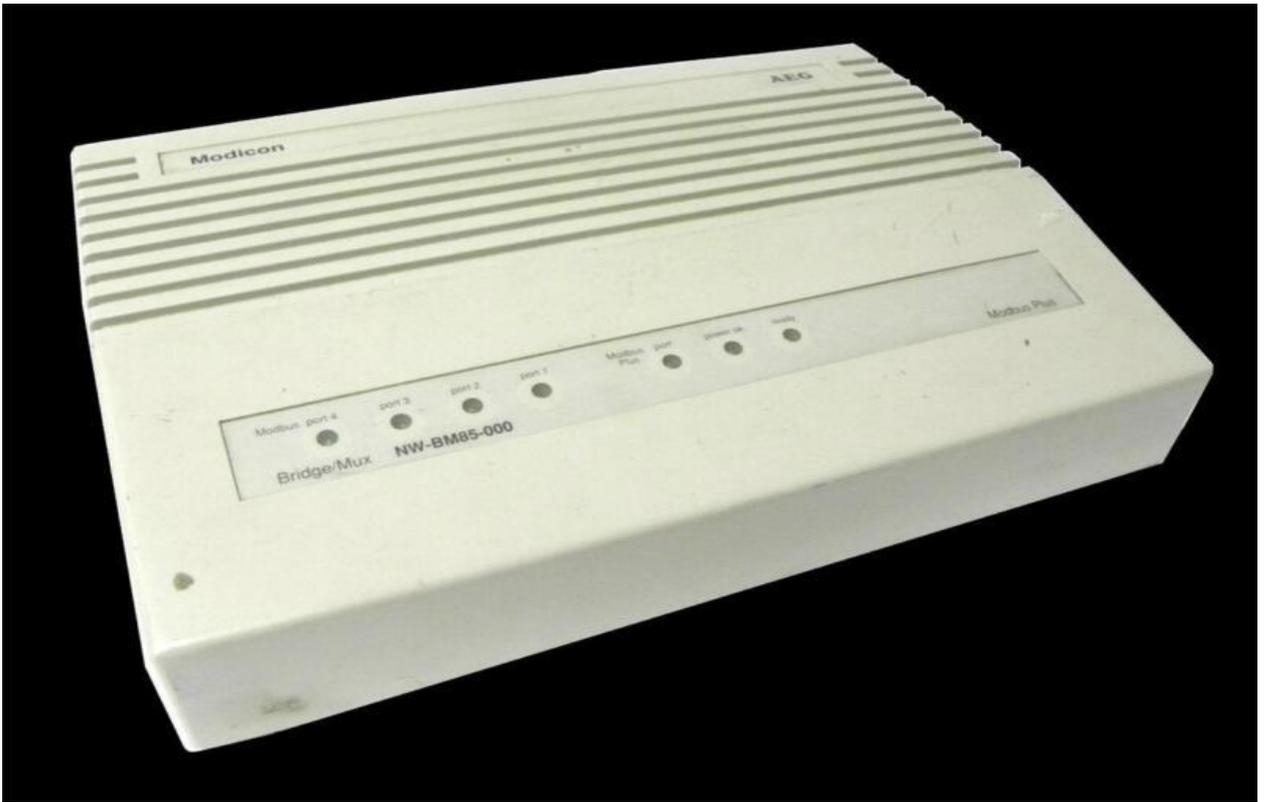
Рисунок 11 - Мост-концентратор данных (мультиплексор) BM-85
