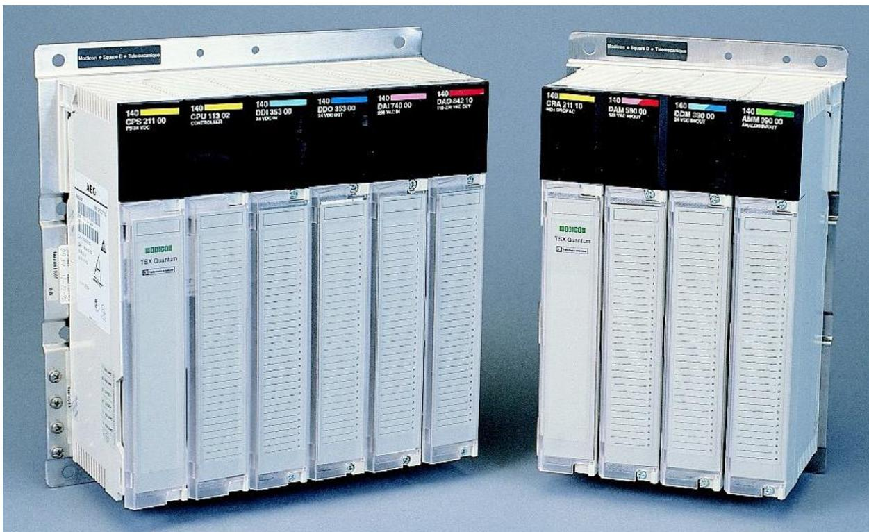
Рисунок 10 - Программируемый контроллер Modicon TSX Quantum
