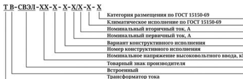
Рисунок 14 – Структура условного обозначения трансформаторов тока ТВ-СВЭЛ
