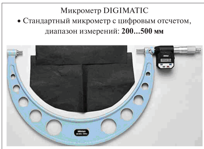
Рисунок 5 – Микрометр для измерения диаметра восстановленной поверхности катка гусеничного трактора
