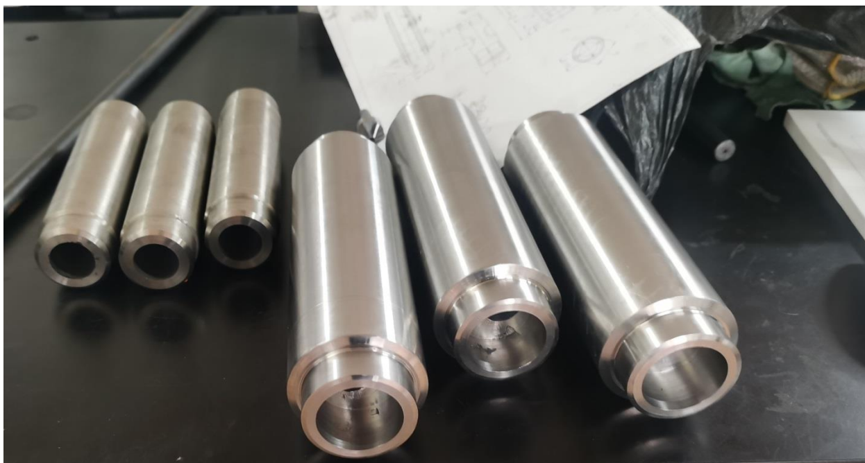
Рисунок 9 - Корпуса датчиков гидростатического давления, изготавливаемые в ООО «Токарка»
