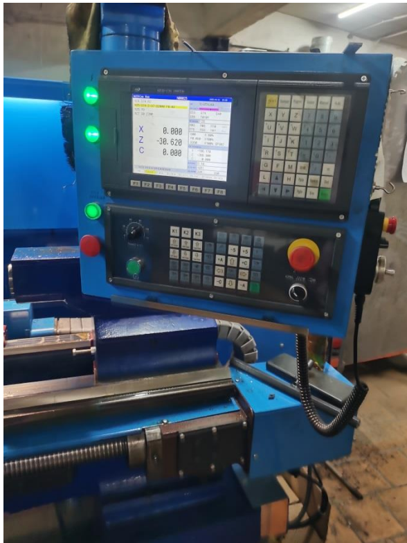
Рисунок 7 - Общий вид стойки системы числового программного управления SZGH1000TDb
