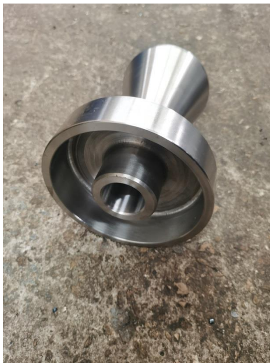
Рисунок 10 - Изготовленный ролик для транспортировки заготовок в литейном производстве ОАО «АВТОВАЗ»
