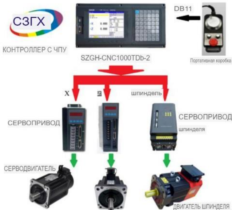
Рисунок 8 - Схема взаимодействия стойки системы ЧПУ SZGH1000TDb
