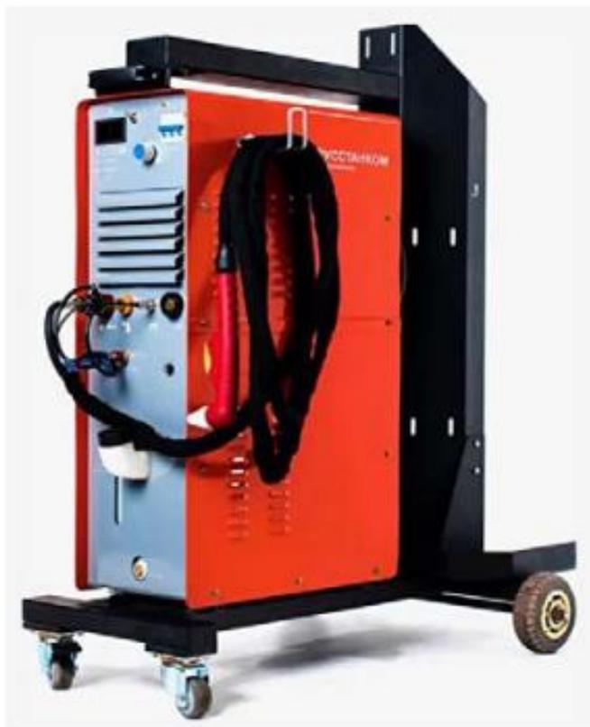
Рисунок 34 – Установка плазменно-дуговой закалки УДГЗ-200
