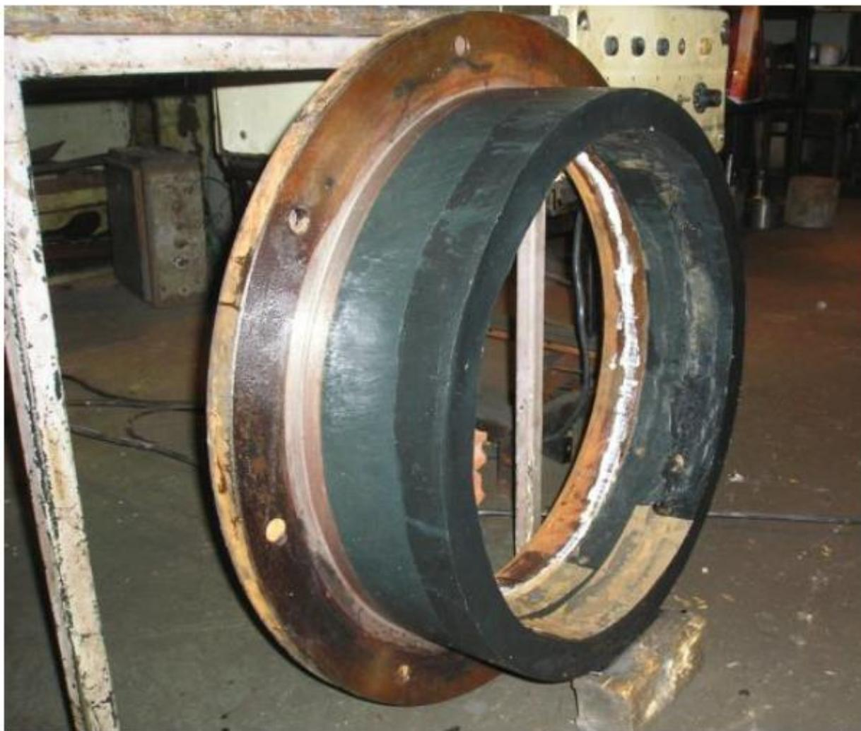
Рисунок 23 – Внешний вид восстановленного кольца грунтового насоса
