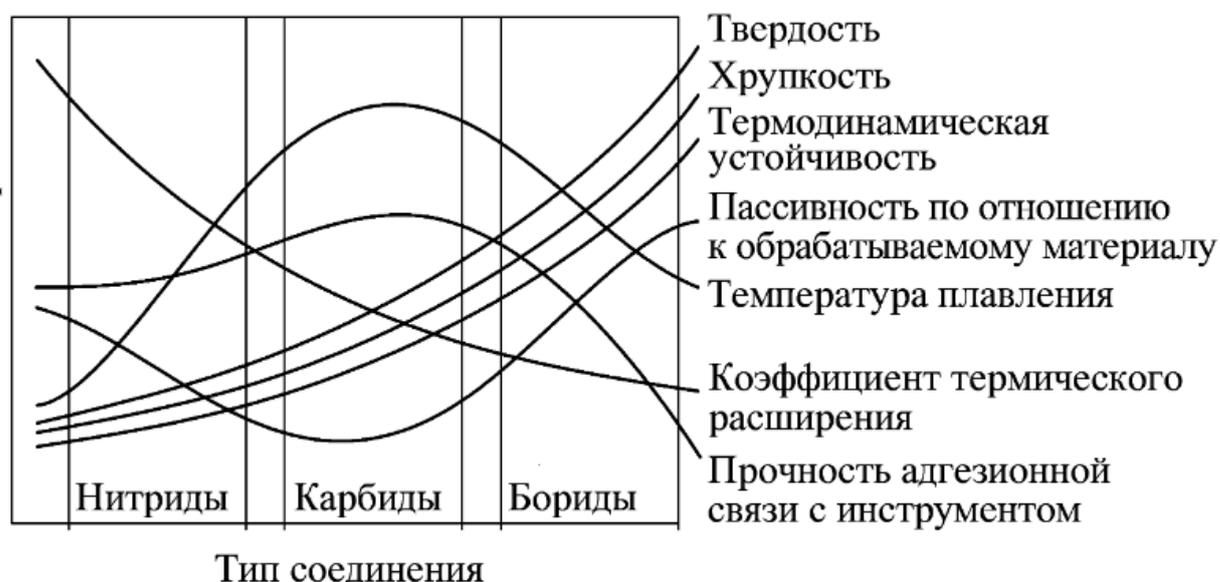
Рисунок 4 – Сравнение физико-механических свойств нитридов, карбидов и боридов
