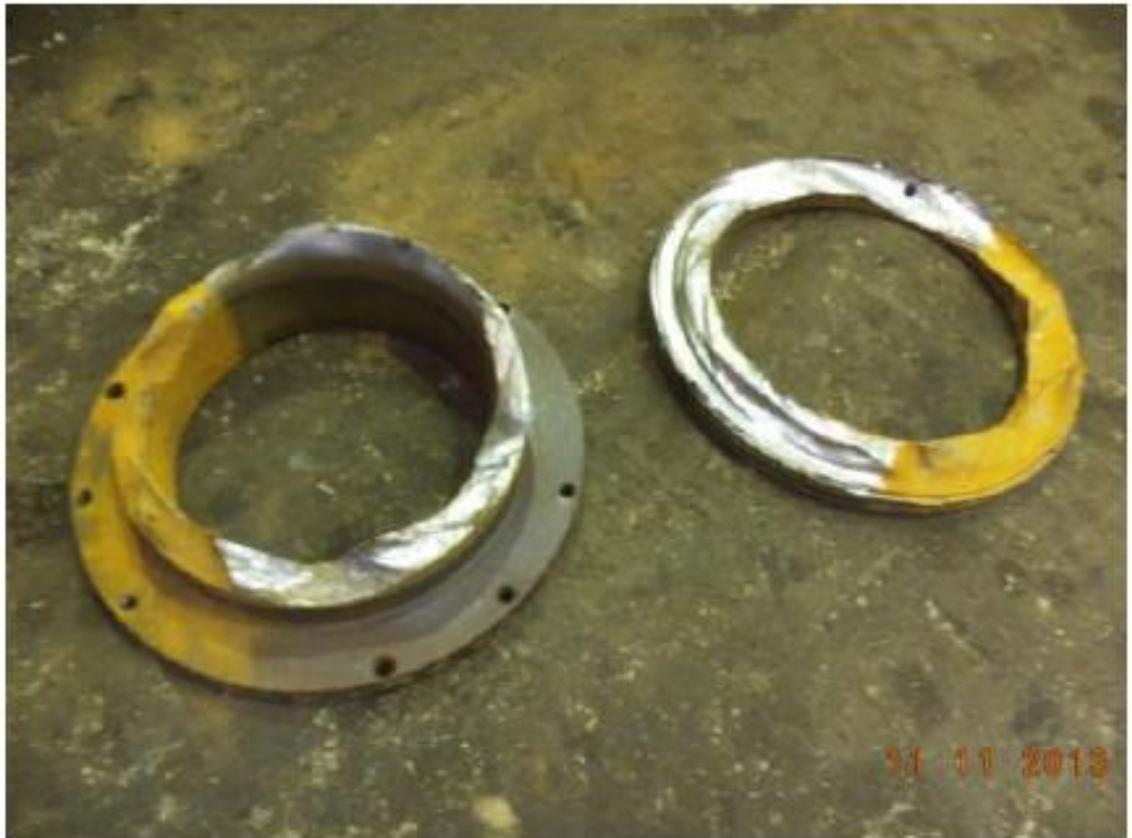
Рисунок 21 – Кольца грунтового насоса
