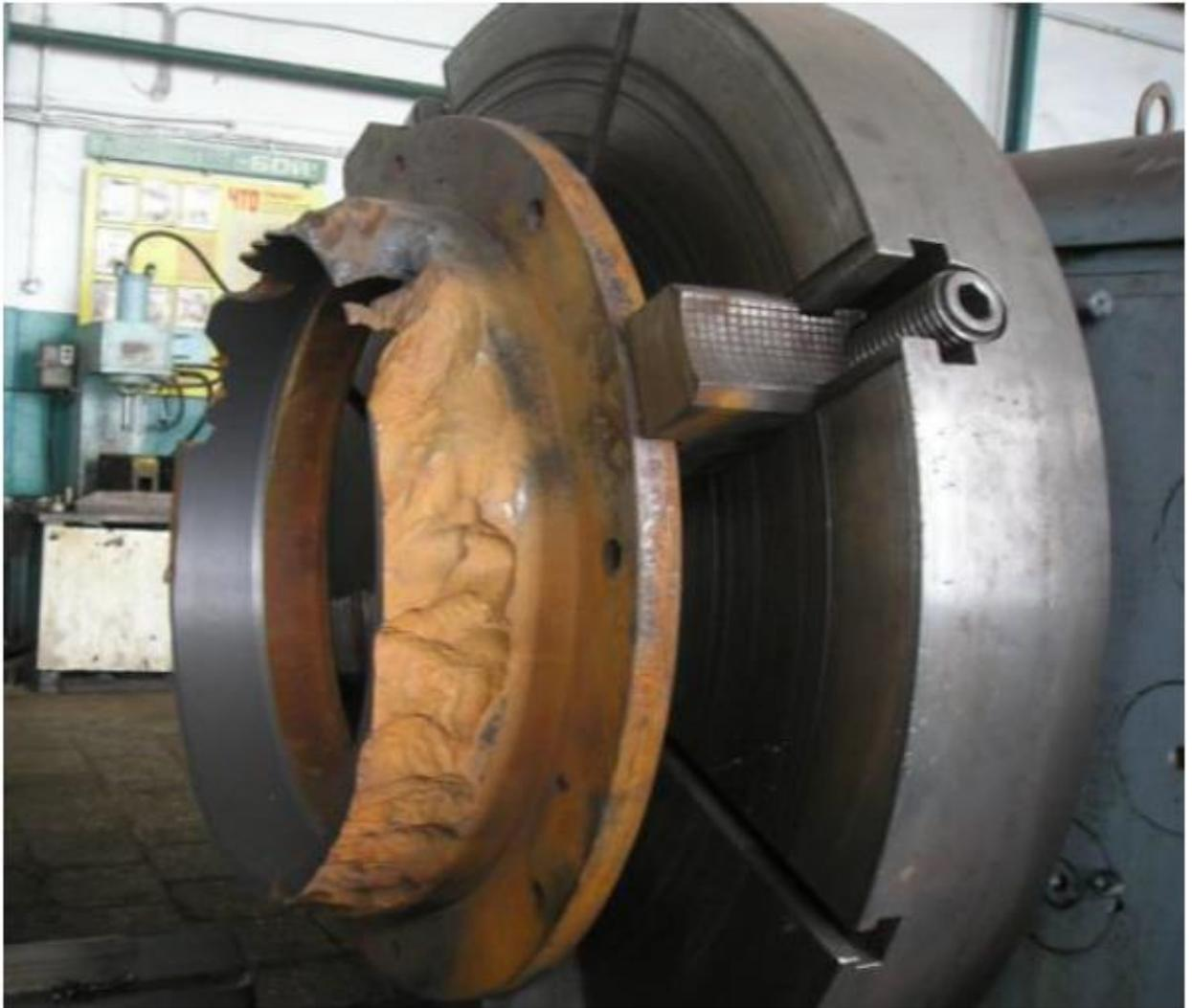
Рисунок 22 – Внешний вид изношенного кольца грунтового насоса
