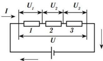
Рис. 7.4. Последовательное соединение проводников
