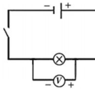
Рис. 7.2. Вольтметр и его подключение в цепь
