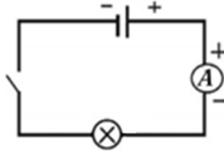
Рис. 7.1. Амперметр и его подключение в цепь
