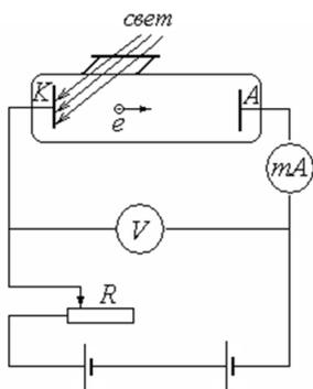
Рис. 10.7. Установка для исследования внешнего фотоэффекта
