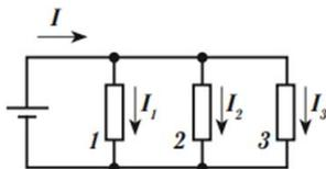
Рис. 7.5. Параллельное соединение проводников
