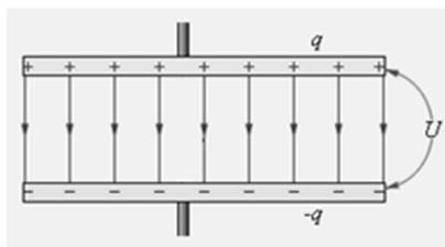
Рис. 6.2. Плоский конденсатор
