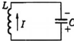
Рис. 9.9. Идеальный колебательный контур
