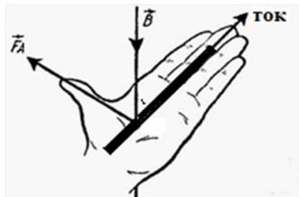
Рис. 8.5. Определение направления силы Ампера по правилу левой руки
