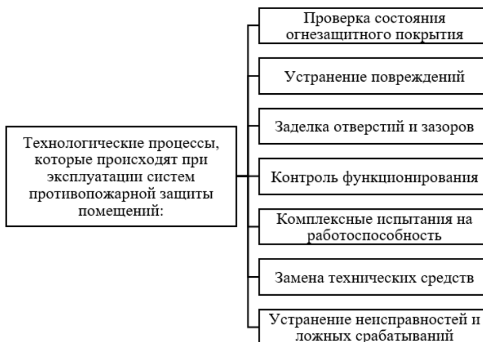
Рисунок 6 – Технологические процессы, которые происходят при эксплуатации систем противопожарной защиты помещений [19]
