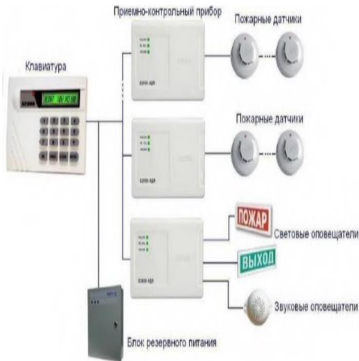
Рисунок 13 – Принципиальная схема размещения элементов АПС
