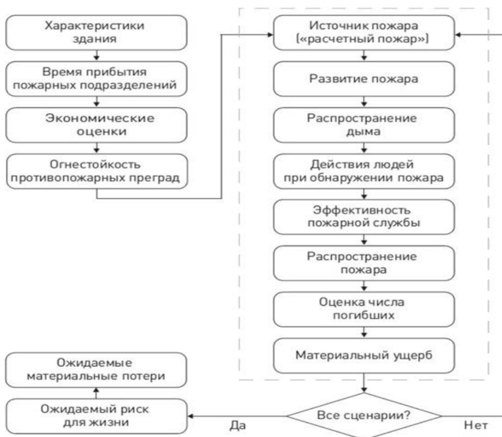
Рисунок 12 – Схема оценки эффективности противопожарной защиты на предприятии
