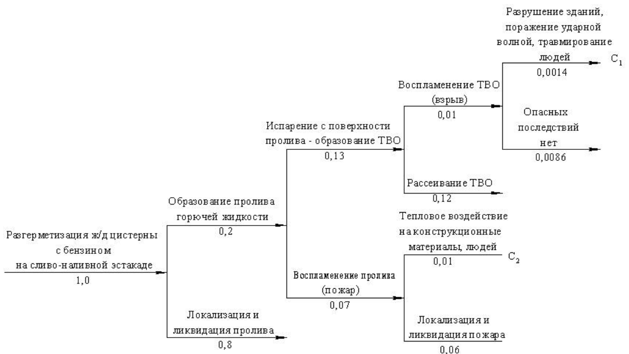
Рисунок 1 – Дерево событий при разгерметизации емкости с бензином
