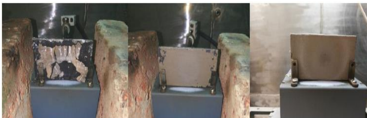
Рисунок 7 – Образцы металла, обработанные огнезащитным составом № 1 после огневого испытания: «образец после воздействия влажности; образец после воздействия теплосмен; образец без воздействий» [3]
