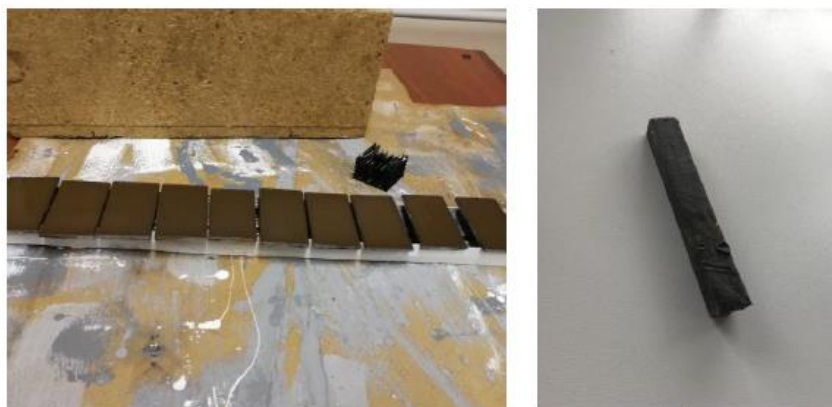
Рисунок 11 – Внешний вид образцов, обработанных огнезащитным средством № 1: металл; древесина
