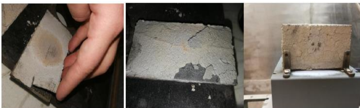
Рисунок 8 – Образцы металла, обработанные огнезащитным составом № 2 после огневого испытания: «образец после воздействия влажности; образец после воздействия теплосмен; образец без воздействий» [3]
