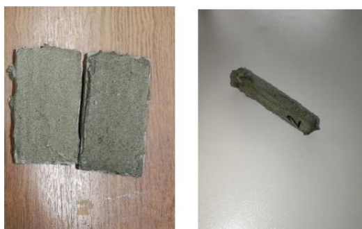
Рисунок 11 – Внешний вид образцов, обработанных огнезащитным средством № 1: металл; древесина
