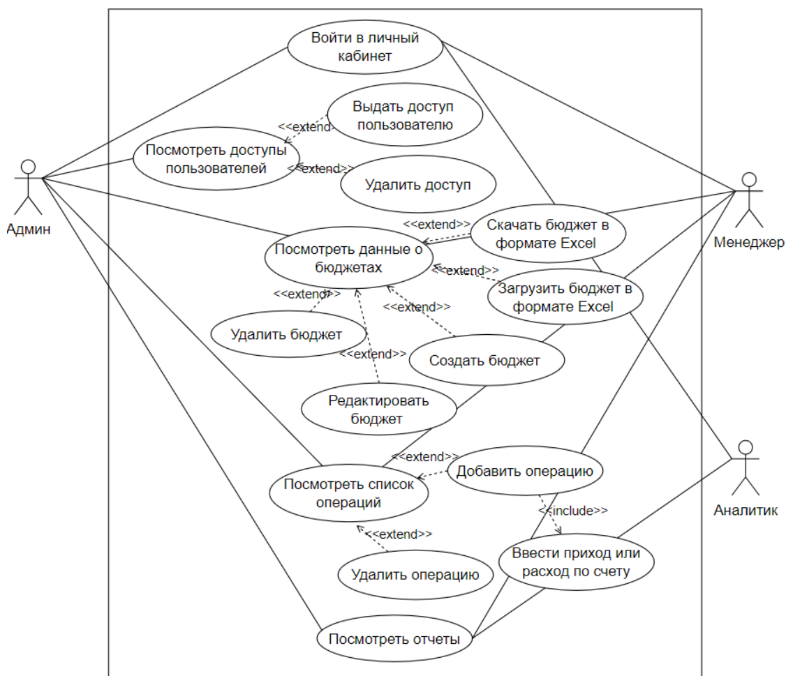
Рисунок 7 – Диаграмма вариантов использования разрабатываемого веб-приложения
