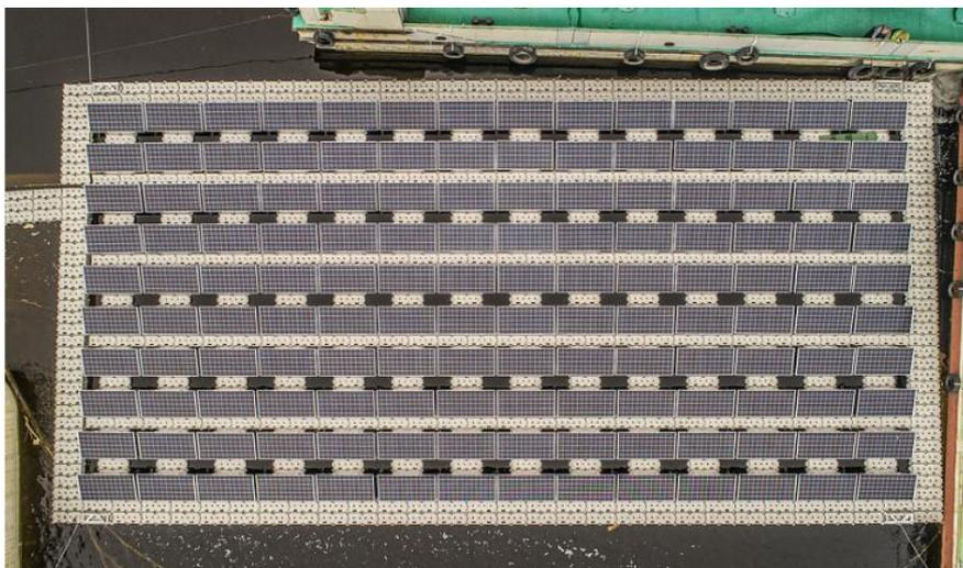
Рисунок 17 – Солнечная понтонная электростанция на Нижне-Бурейской ГЭС
