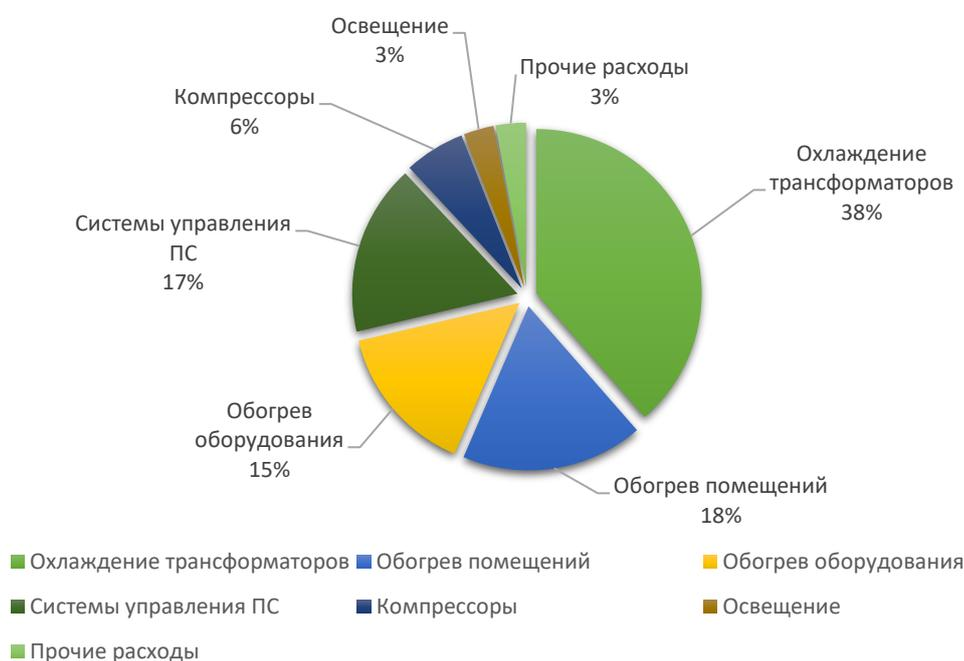
Рисунок 6 – Структура расхода электроэнергии на собственные нужды ПС Хехцир-2
