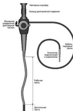
Рисунок 22 – Волокно-оптическая гибкость эндоскопа
