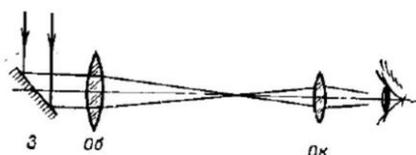
Рисунок 16 – Схема оптической системы эндоскопа
