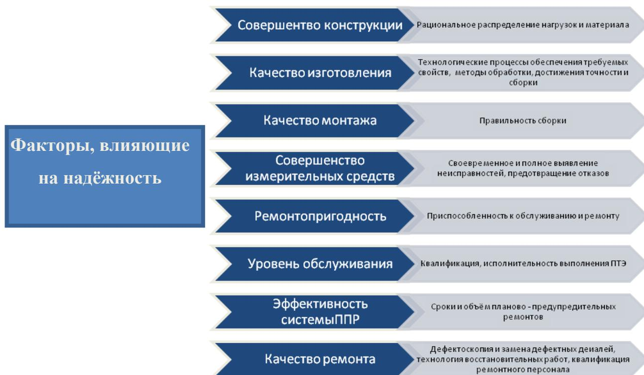
Рисунок 8 – Факторы, влияющие на надёжность турбокомпрессора
