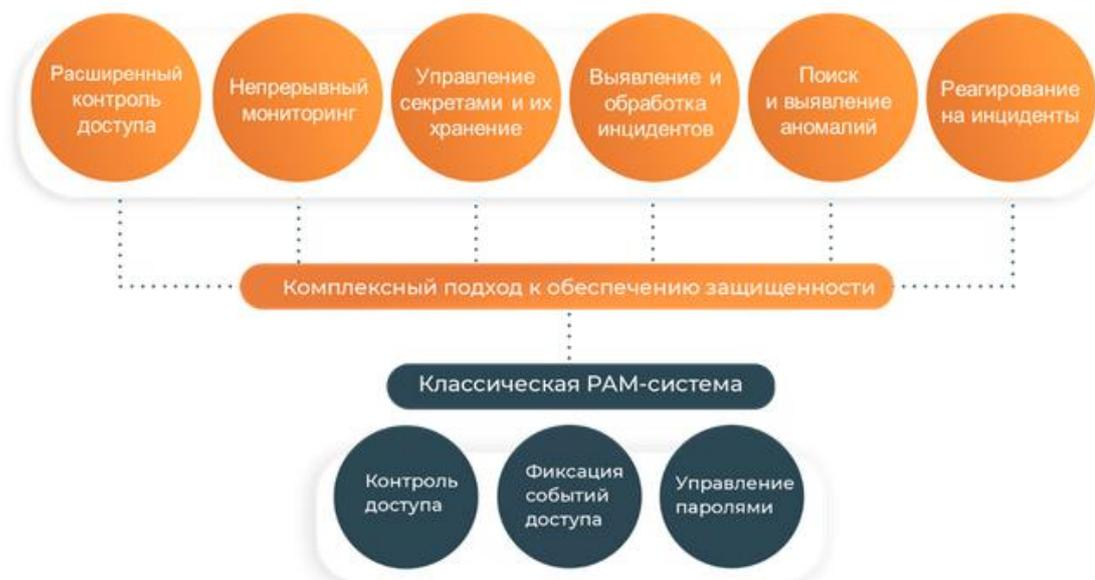
Рисунок 6 – Архитектура системы PAM
