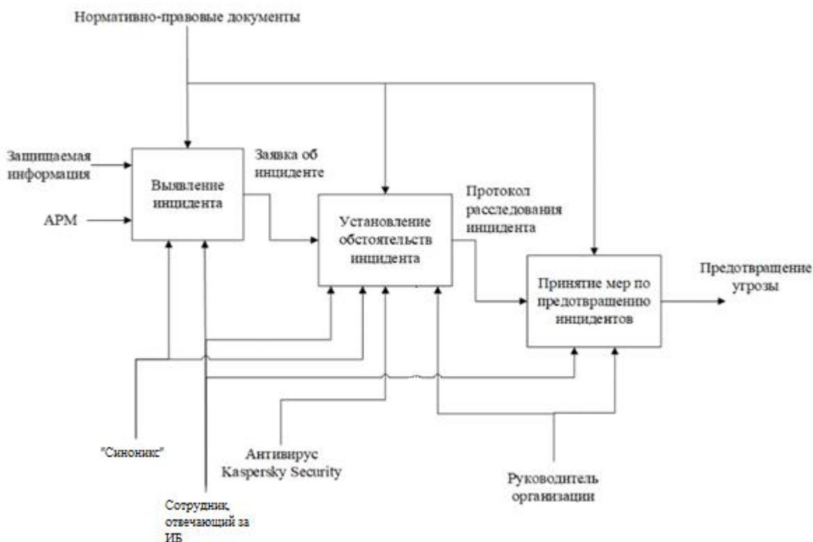
Рисунок 12 – Модель процесса осуществления контроля соблюдения безопасности при использовании и передаче конфиденциальной информации
