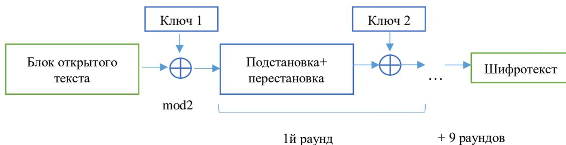
Рисунок 3 – Схема работы алгоритма шифрования «Кузнечик»
