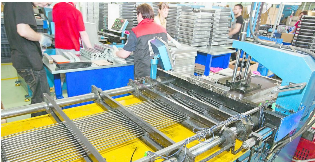
Рисунок 5 – Закрепление ламелей на трубках
