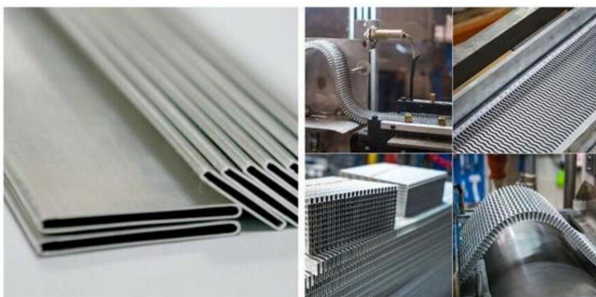
Рисунок 6 – Опорные пластины в сердцевине радиатора
