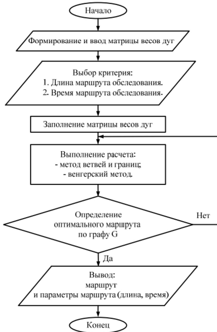
Рисунок 3 – Блок-схема алгоритма определения оптимального маршрута обследования завалов спасателями
